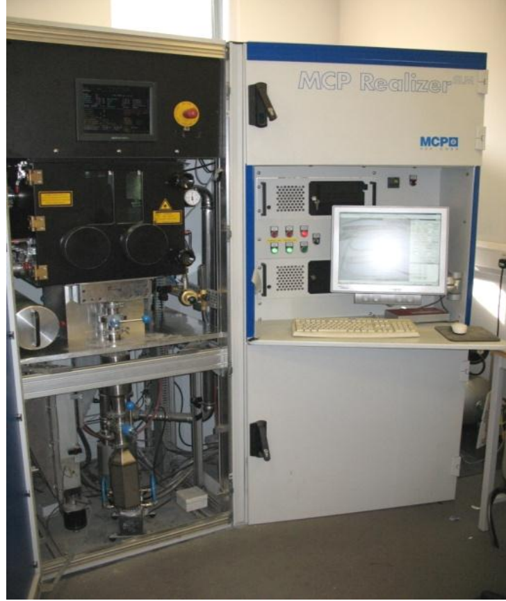
Şekil 2.1. SLM250 Seçici Lazer Ergitme Cihazına ait bir fotoğraf
