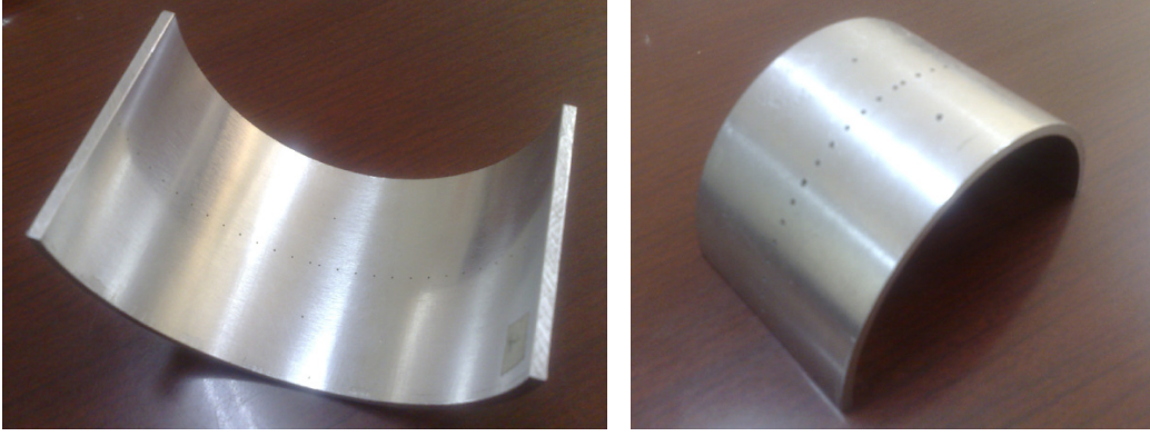
Şekil 2.10. R/L=0.5 plakası için basınç prizi delikleri
