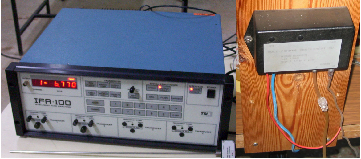
Şekil 2.10. IFA 100 sabit sıcaklık anemometresi ve Modus marka basınçölçer
