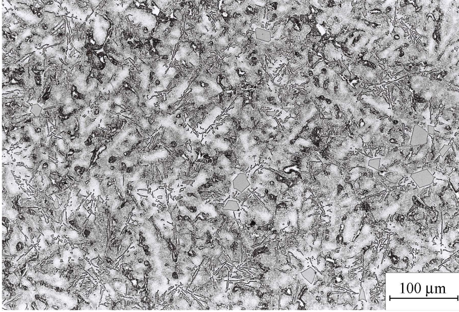
Şekil 21. Dökülmüş durumdaki Al-40Zn-3Cu-5Si alaşımında birincil silisyum parçacıklarının kümeleşmesini gösteren fotoğraf
