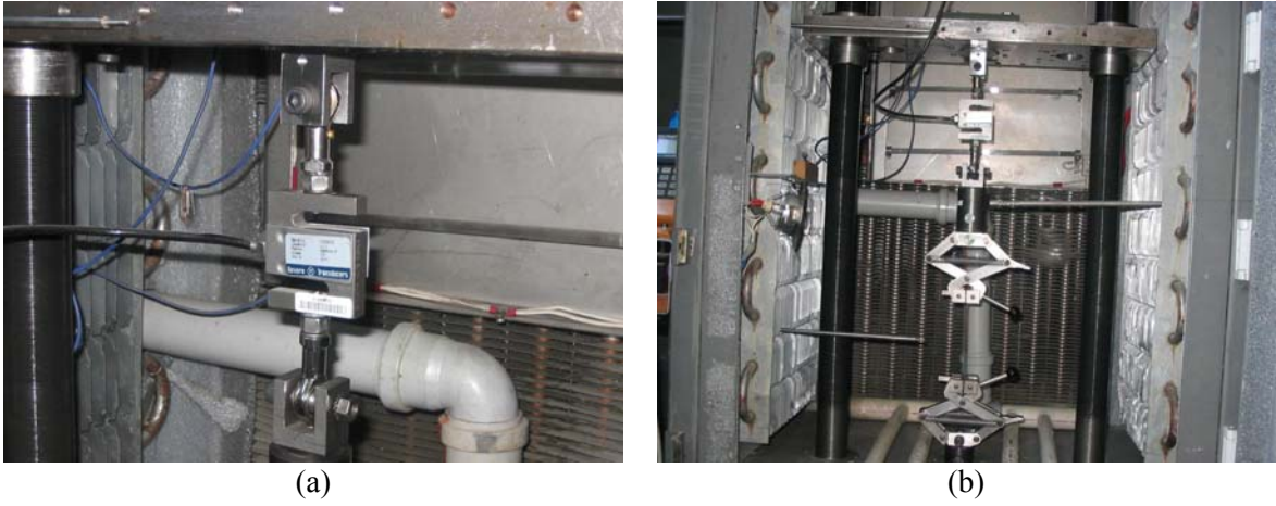
Şekil 17. a) Moment giderici mekanizma, b) Yük hücresinin hareket tablasına bağlantı tertibatı
