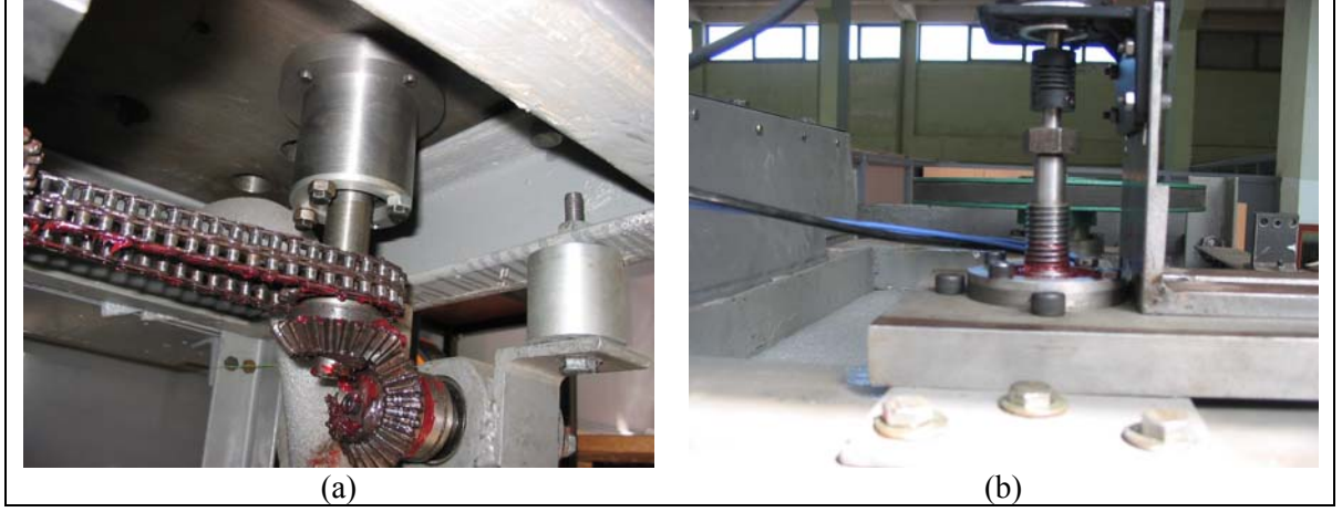
Şekil 14. Tahrik milleri yataklama sistemi
