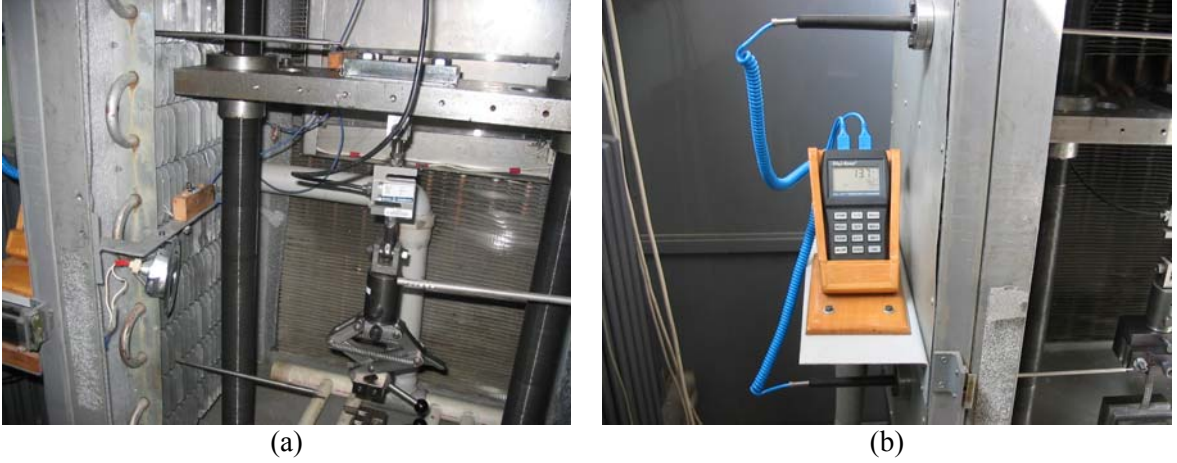
Şekil 25. a) Sıcaklık odasındaki sıcaklığın belirlendiği termokupl sıcaklık problemleri, b) Digital termokupl termometresi
