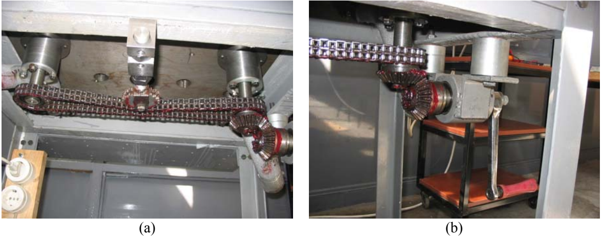
Şekil 15. a) Tahrik millerine zincir dişli çark mekanizması ile hareketin iletilmesi, b) Elle tahrik mekanizması
