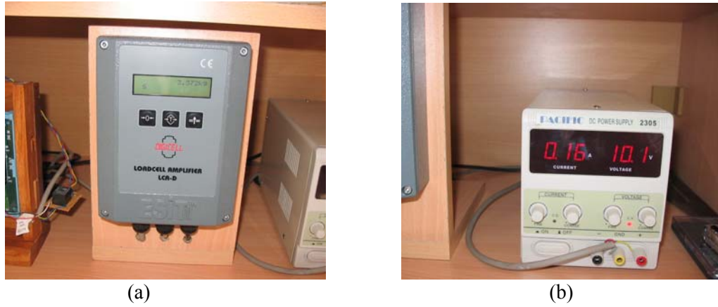
Şekil 18. a) Yük hücresi amplifikatörü, b) DC güç kaynağı
