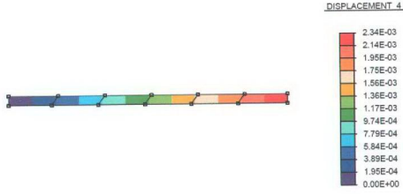
Şekil 3.6. Ankastré kirişte SKQ/SRMQ elemanı için dönme ( \theta_x ) dağılımı
