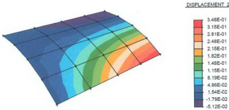
Şekil 3.18. Çatı probleminde SKQ/SRMQ elemanı kullanıldığında Y yönündeki yer değiştirme dağılımı
