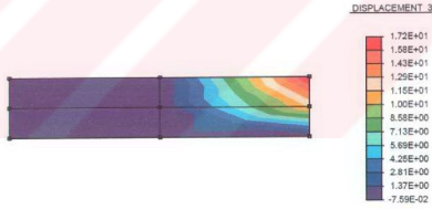
Şekil 3.15. Plak probleminde SKQ/SRMQ elemanı kullanıldığında Z yönündeki yer değiştirme dağılımı
