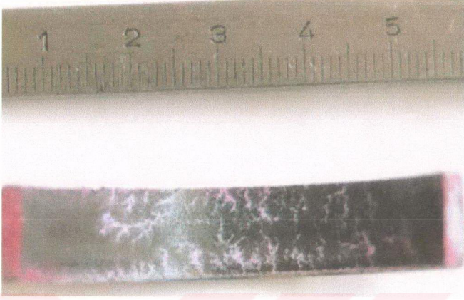
Şekil 131. III nolu yük altında yatakta oluşan yorulma bölgeleri
