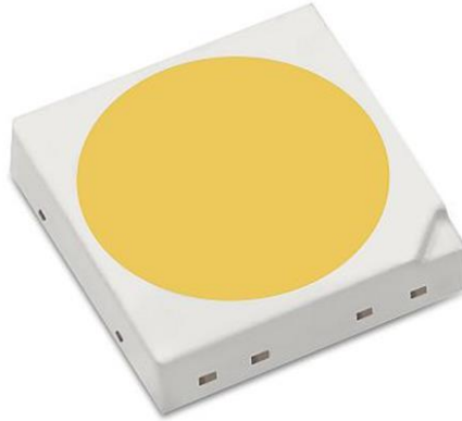
Şekil 13. İç aydınlatma için kullanılan orta güçlü LED [14].
