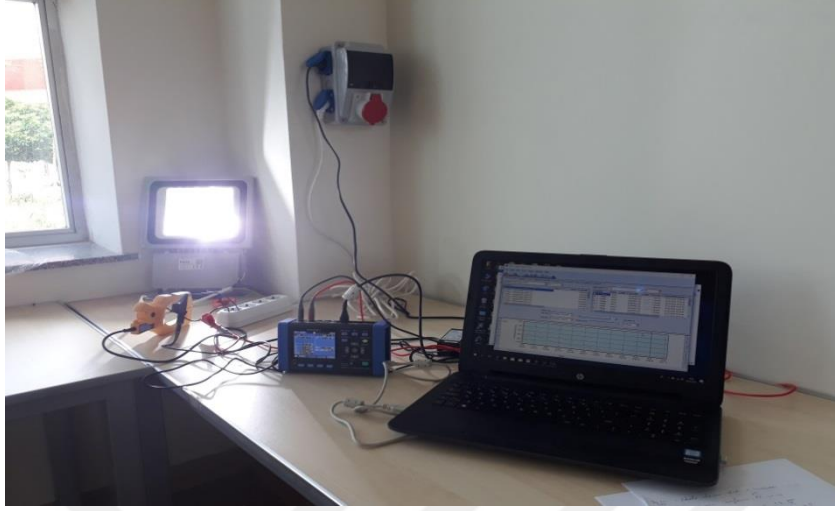
Şekil 79. Şebekeye 70 W LED armatür bağlanması
