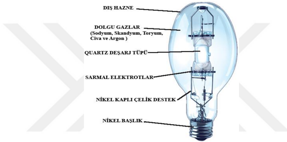
Şekil 7. Metal halojen lamba yapısı [2].
