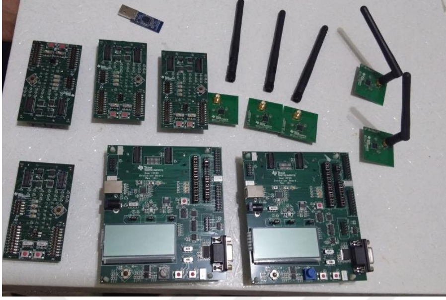
Şekil 19. CC2530 ZigBee geliştirme kiti [45]
