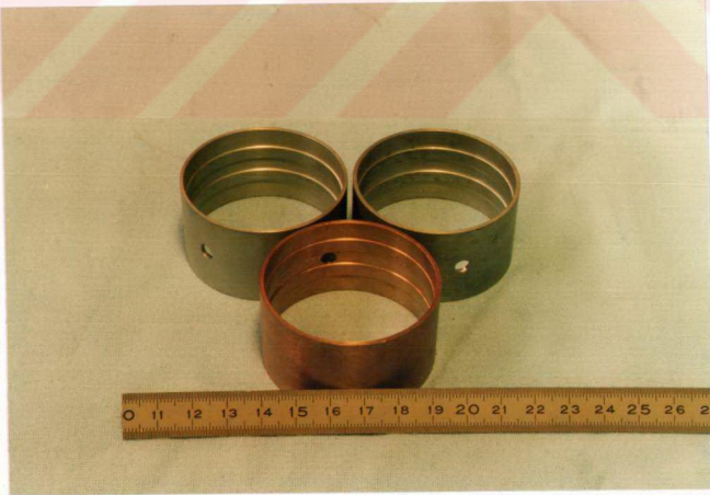
Şekil 13. Sürtünme deneylerine tabi tutulan kaymalı yatakların görünümü
