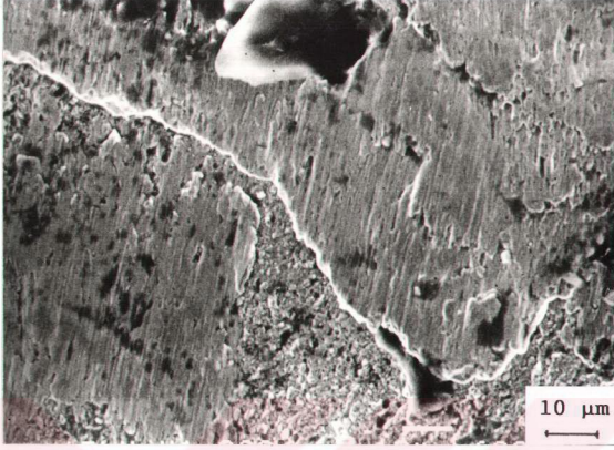
Şekil 39. 30 kN'luk yük altında, yağsız olarak çalıştırılmış bir rulmanın iç bileziğinin yuvarlanma yolu üzerinde görülen sürtünme, çizilme ve aşınma izleri
