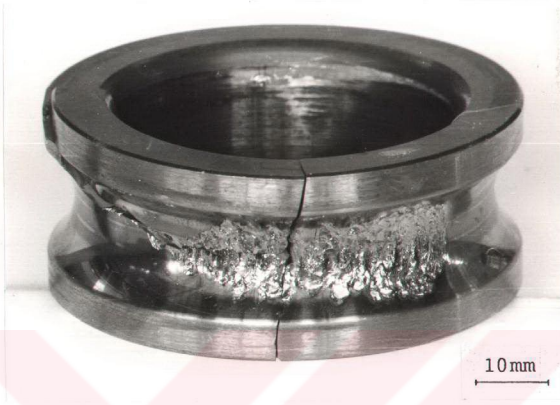
Şekil 29. 33 kN'luk yük altında ve 0,5 l/dak'lık yağ debisinde çalışan rulmanın hasara uğrayan iç bileziğinin görünümü
