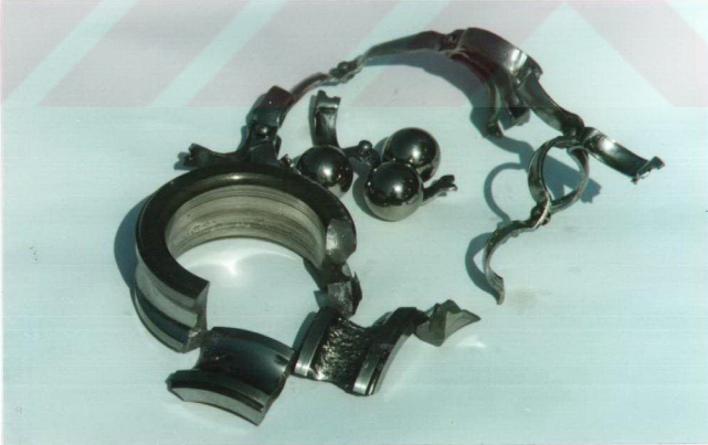
Şekil 30. 33 kN'luk yük altında ve 0,5 l/dak'lık yağ debisinde çalışan rulmanın hasara uğrayan elemanları
