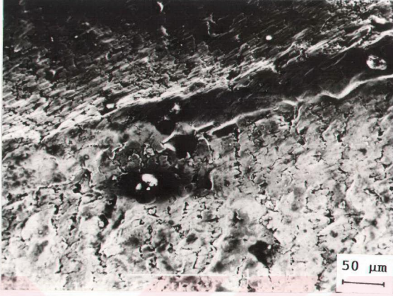
Şekil 35. 40 kN'luk yük, 6000 dev/dak'lık mil hızı ve 0,5 l/dak'lık yağ debisinde çalışan rulmanın bir bilyasının yüzeyinde meydana gelen sürtünme izleri ile çatlakların görünümü
