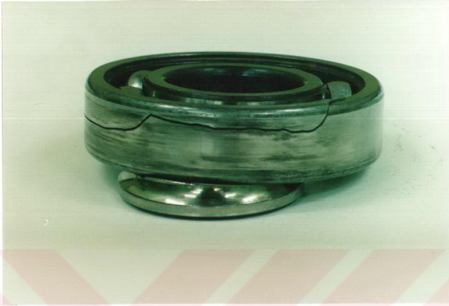
Şekil 31. 52 kN'luk yük altında ve 1,0 l/dak'lık yağ debisinde çalışan rulmanın aşırı zorlama sonucunda hasara uğrayan iç ve dış bilezikleri
