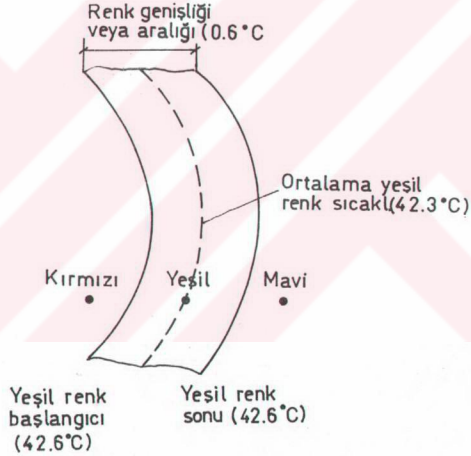
Şekil 18. Sıvı kristalin renk aralığı ve ortalama renk sıcaklıkları.
