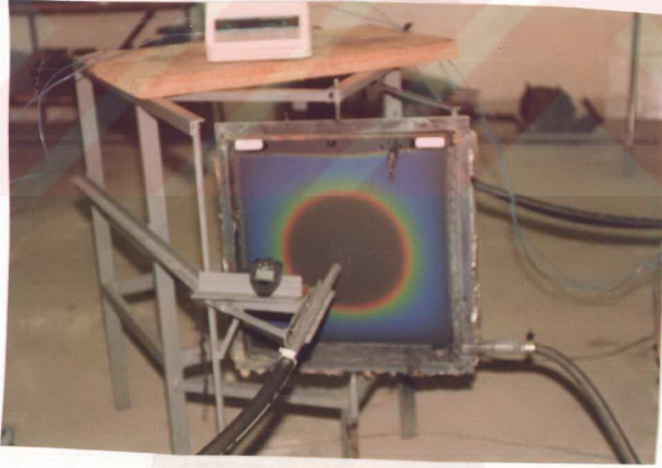
Şekil 15. Yüzeğe ince uygulanmış sıvı kristalin renkleri.
