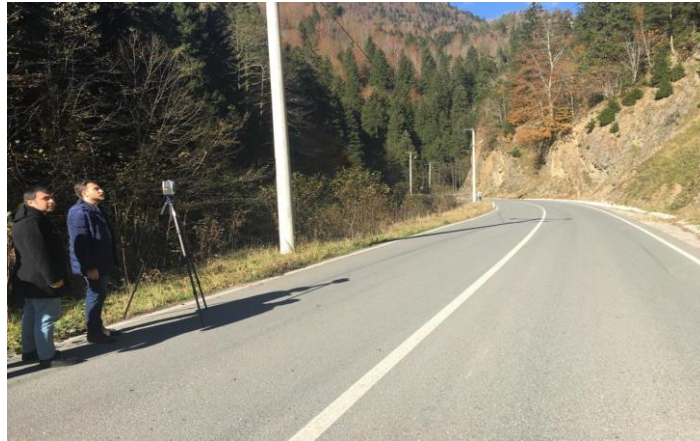
Şekil 25. Çalışma lokasyonlarını yersel lazer tarama cihazı kullanarak tarama
