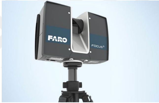
Şekil 24. Çalışma alanlarında kullanılan yersel lazer tarama cihazı
