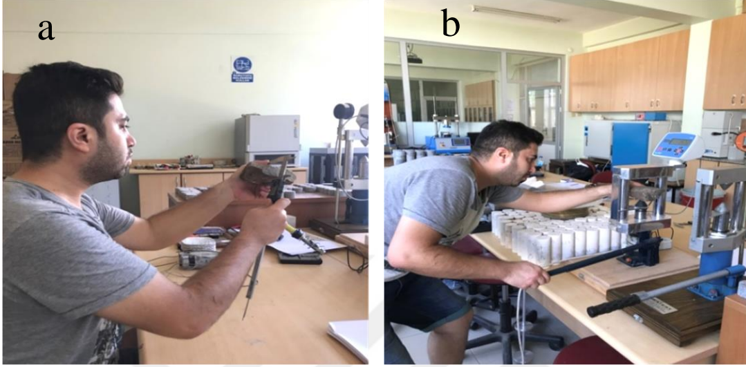
Şekil 43. a) Kumpas kullanarak düzensiz şekilli kaya örneklerin genişlikleri ve kalınlık ölçümleri. b) Şekilsiz kaya blokların üzerinde uygulanan nokta yükü dayanım indeksi deneyi
