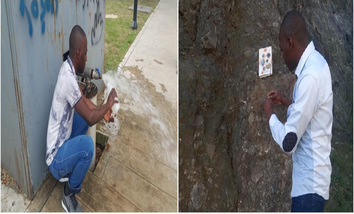
Şekil 9. Tekkeköy belediyesine ait sondaj kuyusundan su örneği alımı
