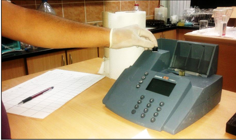
Şekil 3.9. Laboratuvarında kullanılan fotometre ölçüm cihazı
