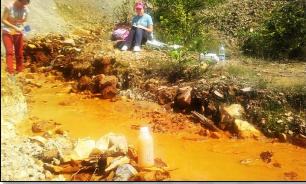
Şekil 1.1. Eseli maden sahasında gözlenen asit maden drenajı
