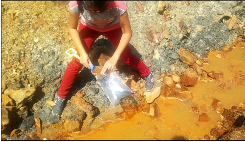
Şekil 3.5. Eseli maden sahasında dere sedimanı örnekleme
