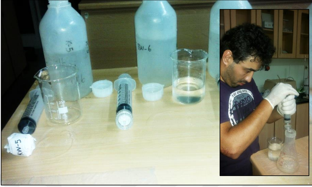
Şekil 3.8. Laboratuvar ortamında su örneklerine uygulanan filtreleme işlemi
