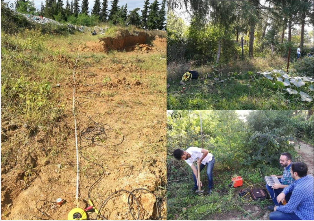
Şekil 3.4. MASW yönteminin arazide uygulanışı
