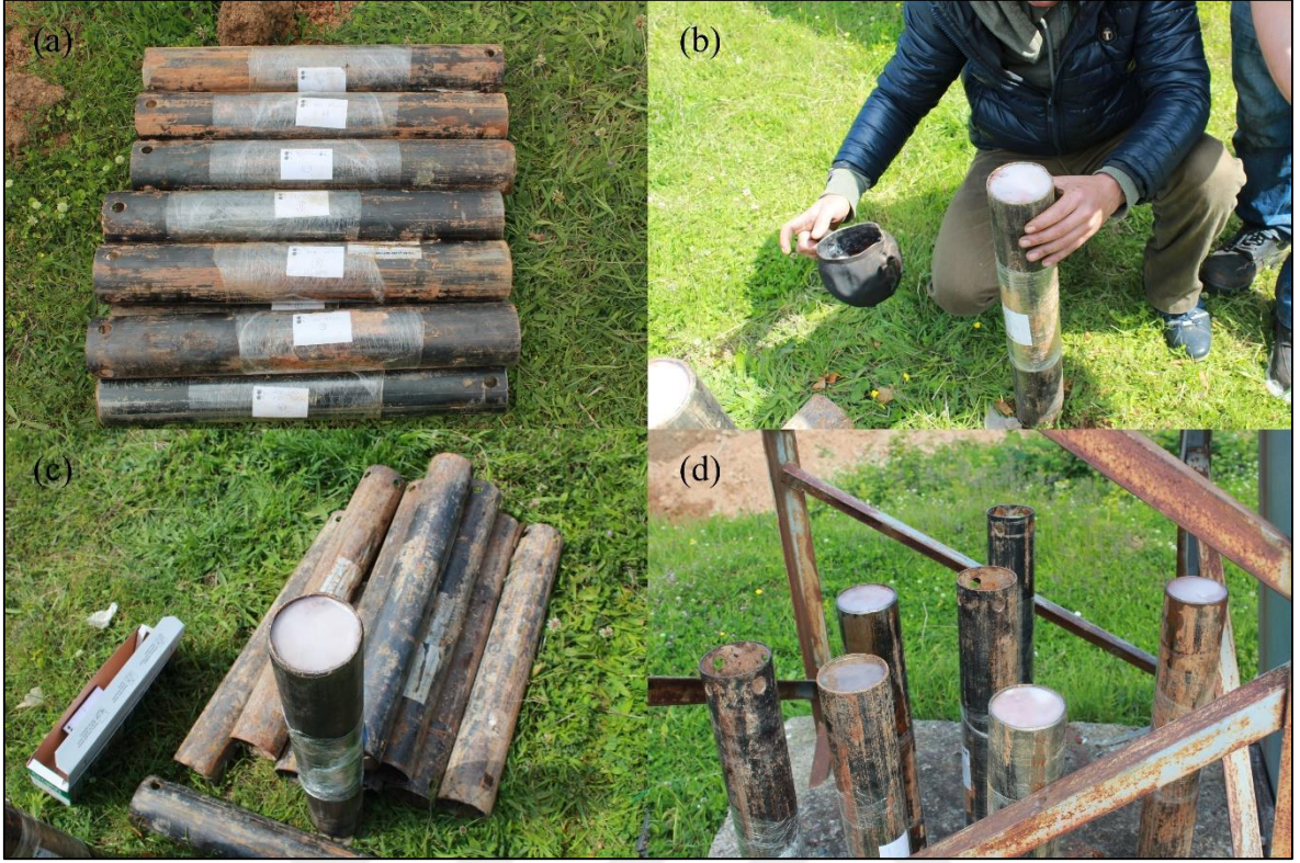
Şekil 3.16. 86 mm çaplı, 50 cm uzunluğundaki karotiyerler (a), parafinlenme işlemi (b) ve parafinlenen örneklerin kurumaya bırakılması (c) ve (d)
