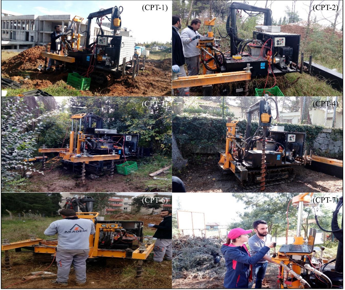
Şekil 3.17. Koni Penetrasyon deneyinin farklı kuyulardaki uygulanişı (CPT-1-7)
