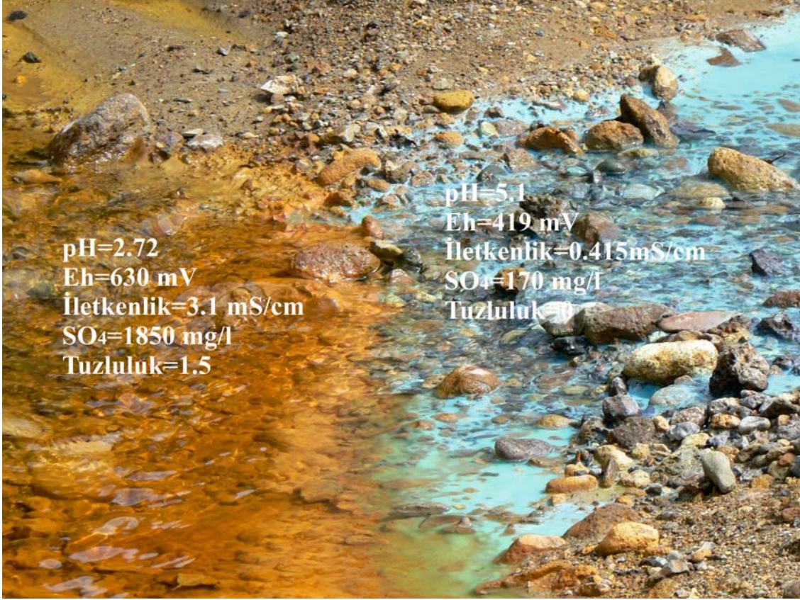
Şekil 5.4. Karaerik Maden sahasındaki galeri dışarı etkisi altında olan schwertmannit çökelinin gerçekleştiği Acısı Dere (kahverengi) ile cüruf etkisi altında olan kalkoalümit çökelinin gerçekleştiği dere (mavi). Resim üzerinde yağışlı sezonda ölçülen parametre değerleri belirtilmiştir.
