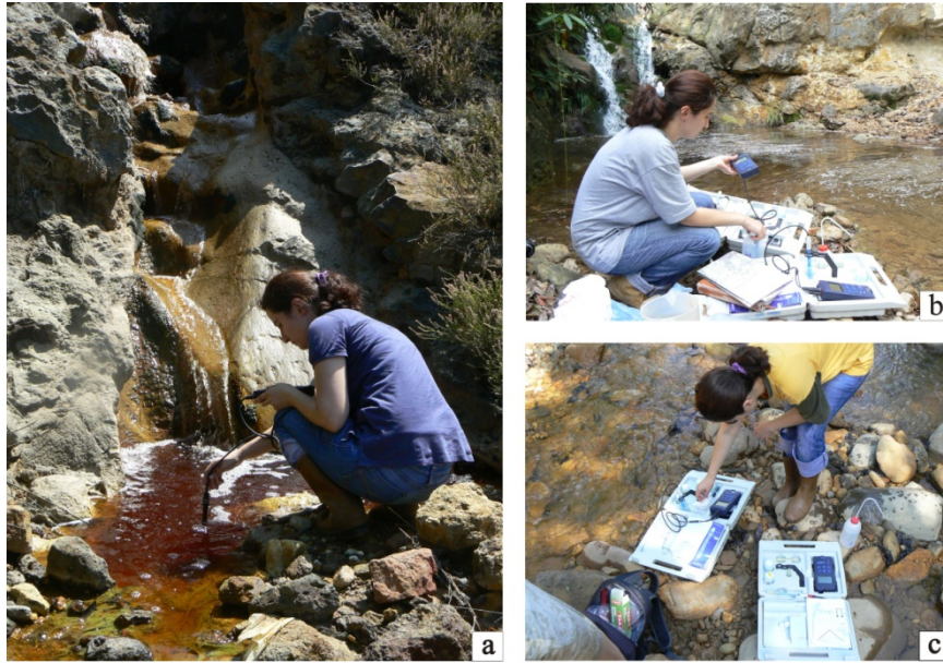
Şekil 3. 5. a) Acısu Deresi' nde yapılan iletkenlik ölçümü, b) Kozköy Karagöz Deresinden alınan örnekte pH ölçümü, c) Lahanos Kızıl Dere üzeri pH ölçümü
