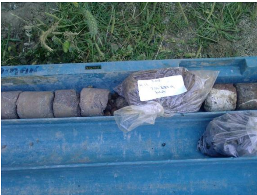
Şekil 7. Sinop merkez ilçesinde yapılan sondaj çalışmaları ve zeminlerden alınan karot örneklerine ait görüntüler (Sinop Belediyesi, 2010).
