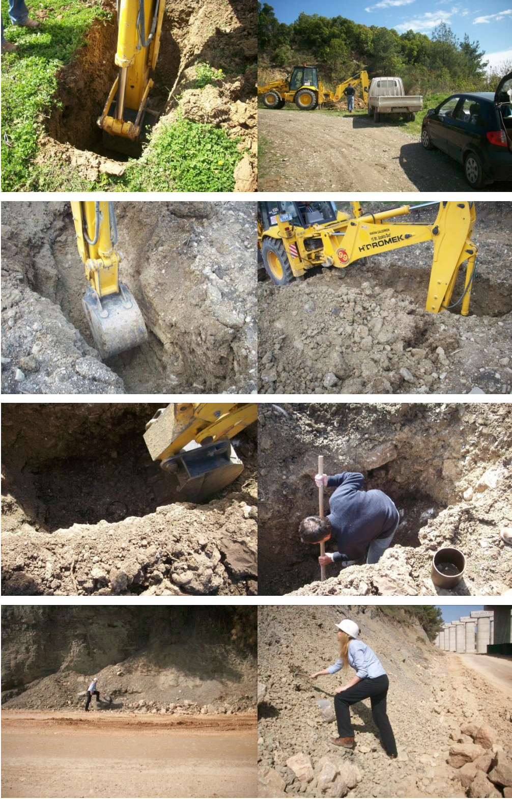
Şekil 6. Gerze ilçesinde yapılan arazi çalışmaları sırasında farklı alanlarda açılan araştırma çukurlarında gerçekleştirilen örnek alımı işlemi
