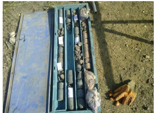
Şekil 7. Sinop merkez ilçesinde yapılan sondaj çalışmaları ve zeminlerden alınan karot örneklerine ait görüntüler (Sinop Belediyesi, 2010).
