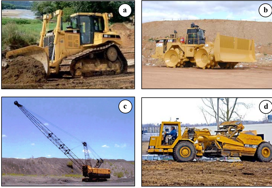
Şekil 3.60. Düzenli depolama alanında kullanılan iş makineleri, a: paletli dozer (crawlers), b: çelik tekerlekli kompaktör, c: vinç (dragline) ve d: kendinden yüklemeli scraper
