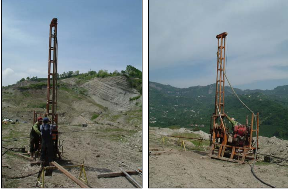
Şekil 3.26. Taş ocağının üst kotlarında açılan sondajlar (kot: 185 m)
