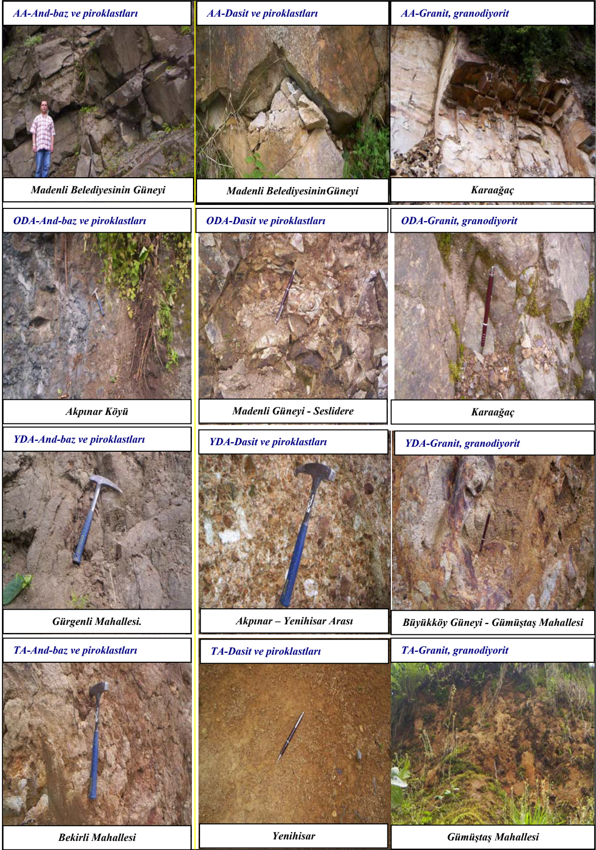
Şekil 24. İnceleme alanında kayalardaki farklı ayrışma dereceleri.
