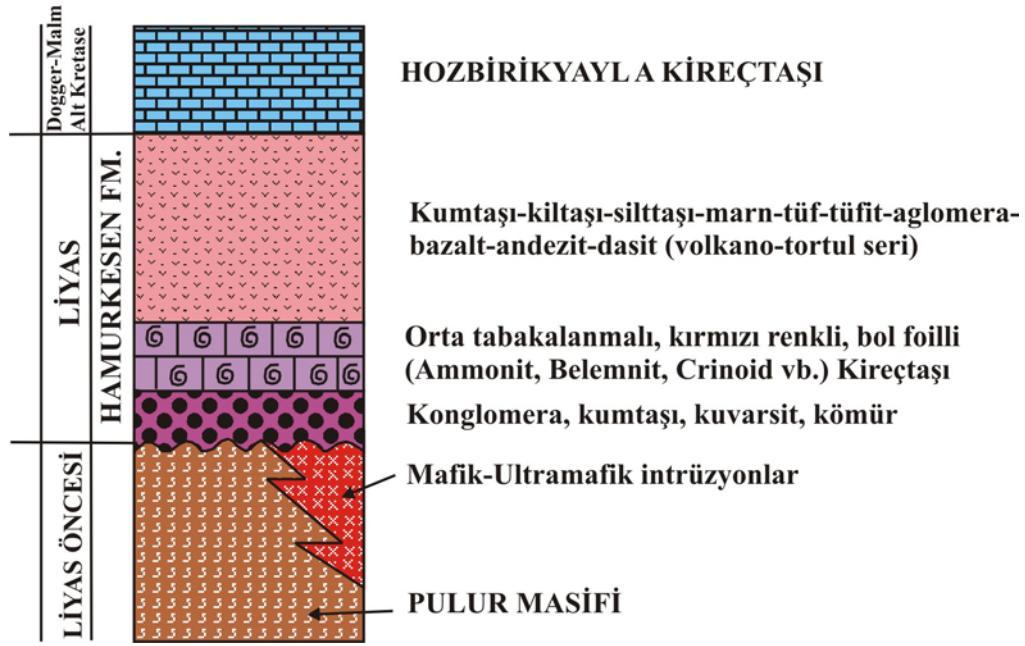
Şekil 61. Hamurkesen Formasyonu'nun inceleme alanındaki litolojik birliklerini gösteren basitleştirilmiş dikme kesiti.
