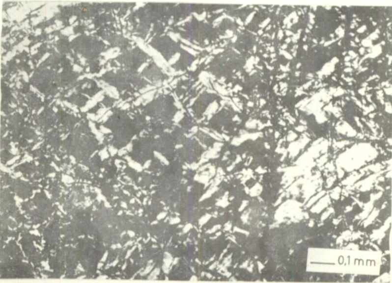
Foto 38 Serpantinitlerde gelişmiş ağ strüktürü (çap.nik. \times 58 , Örnek No 142).
