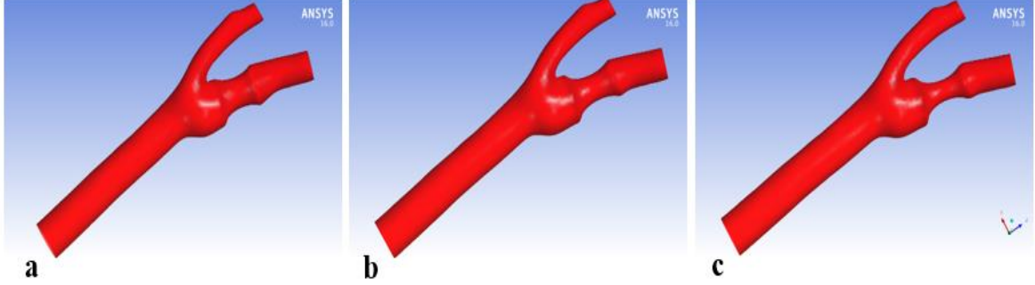
Şekil 14. a) %30 daralmış karotis arter b) %60 daralmış karotis arter c) %80 daralmış karotis arter
