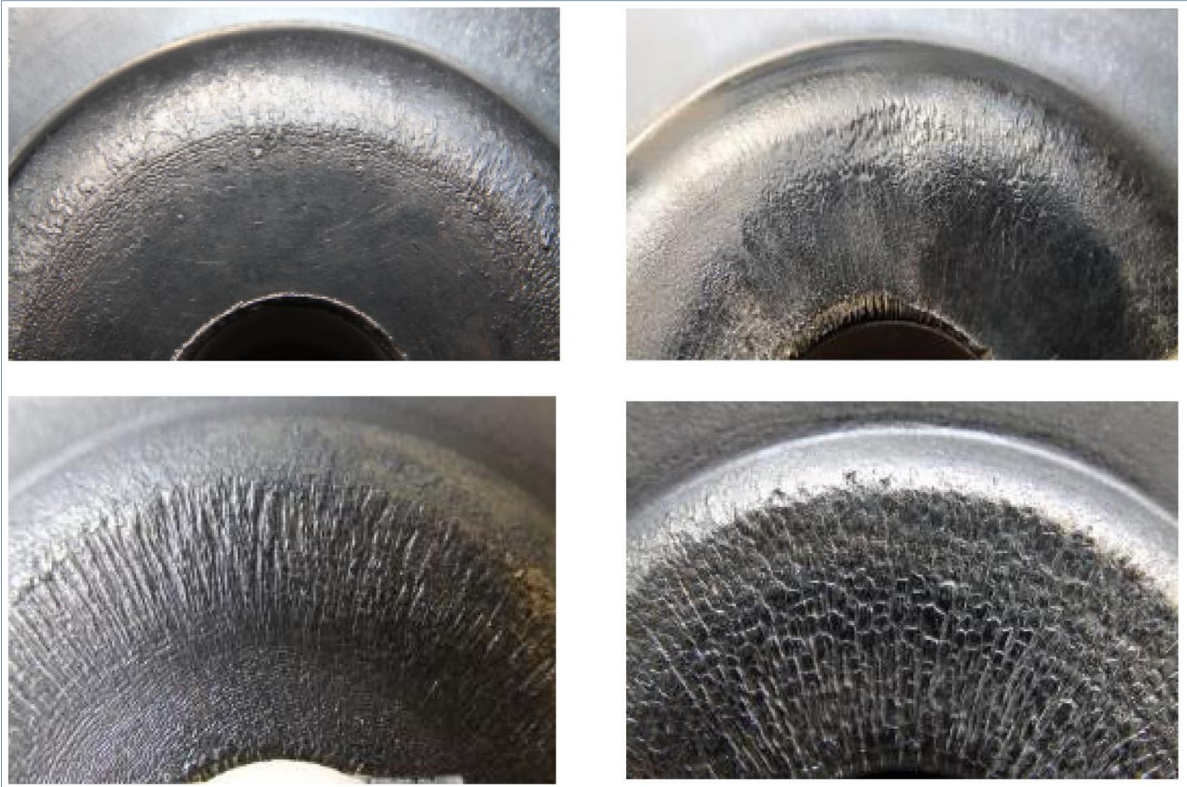
Şekil 37. Dövme kalıplarında meydana gelen termo-mekanik çatlak ağı [76].
