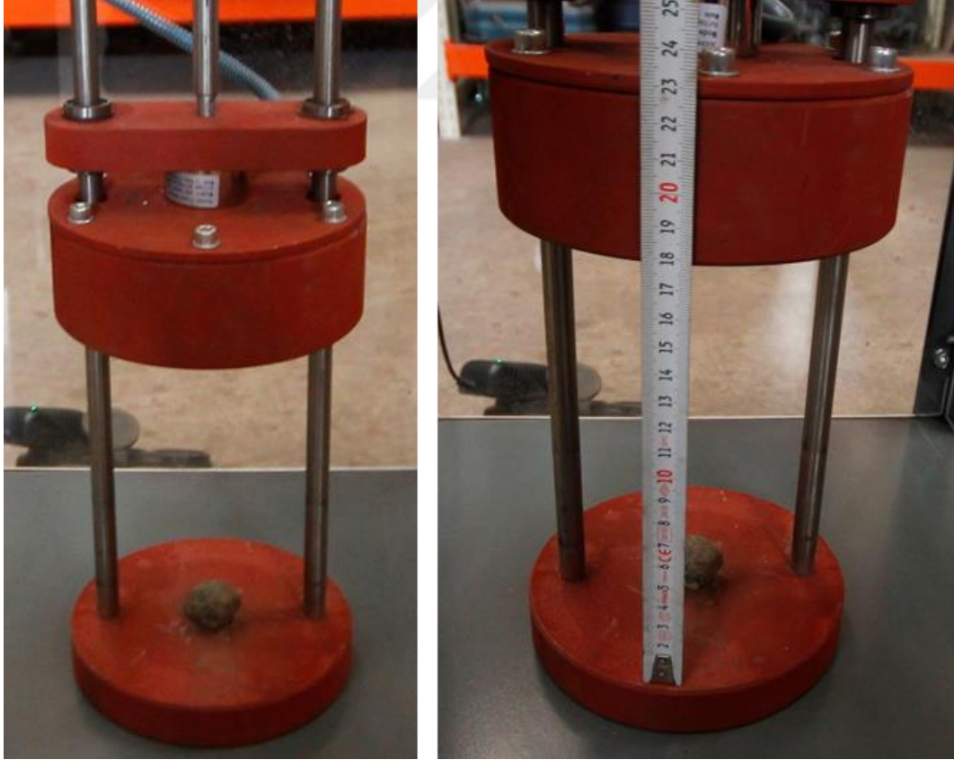
Şekil 34. Ağırlık düşürme testi
