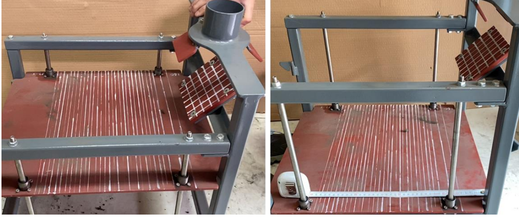
Şekil 26. St-37 plaka için geri sıçrama katsayısı testi
