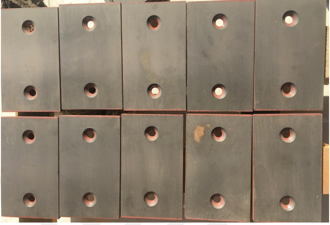
Şekil 39. Aşınma testi sonucu aşınan plakalar
