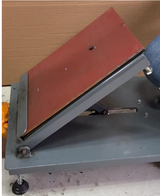
Şekil 22. Kinetik sürtünme katsayısı için eğik düzlem testi (St-37)
