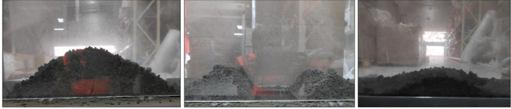
Şekil 31. Yığın ve düşme açısı testi
