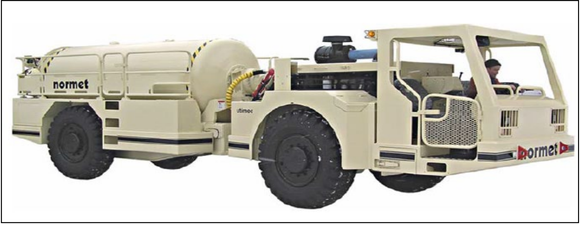
Şekil 27. Çalışmaya konu olan yer altı yatay mikseri [12].
