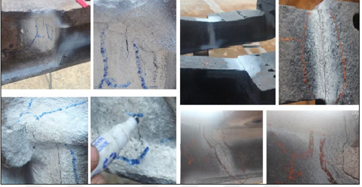
Şekil 83. Alt şasi ile üst şasi arasındaki kaldırma silindirlere ait bağlandığı, alt şasiye ait bölgedeki hatalar
