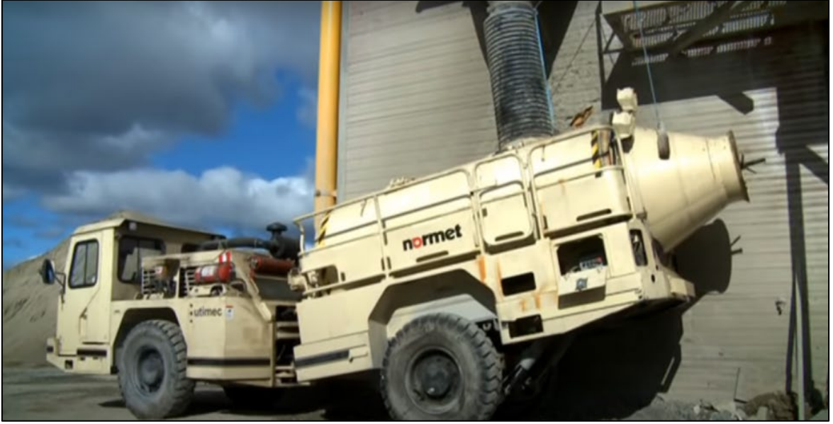
Şekil 31. Mikser kazanına beton doldurulması [12].
