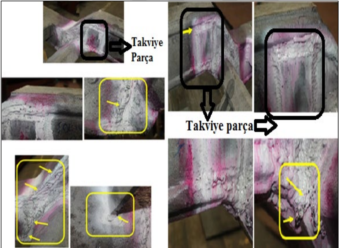
Şekil 78. Üst şasinin arka kısmında görülen hatalar
