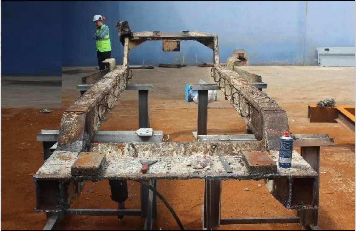
Şekil 35. Aracın üst şasisinin, aracın demontajının ardından arkadan görünüşü
