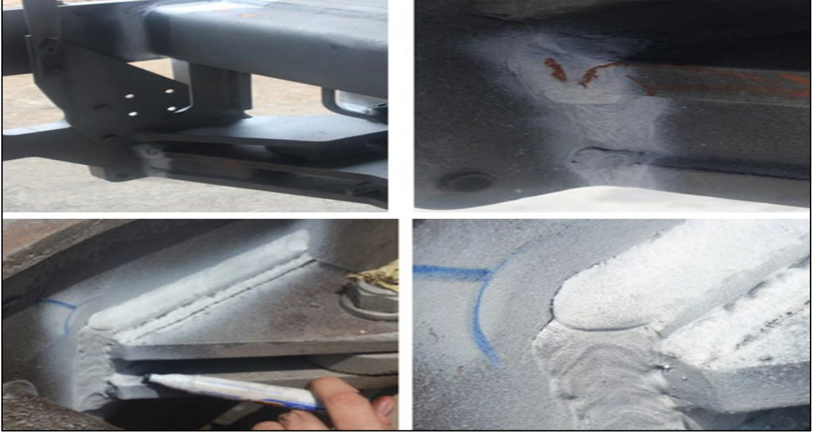
Şekil 80. Alt şasinin ön kısmındaki dönüş silindirlerinin şasiye bağlantı braketlerinin kaynaklı bölgelerindeki hatalar
