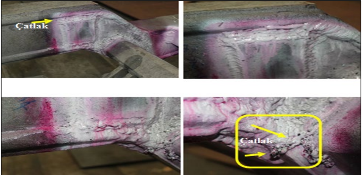
Şekil 45. Üst şaside belirtilen 4 numaralı kısma ait detay görüntüler
