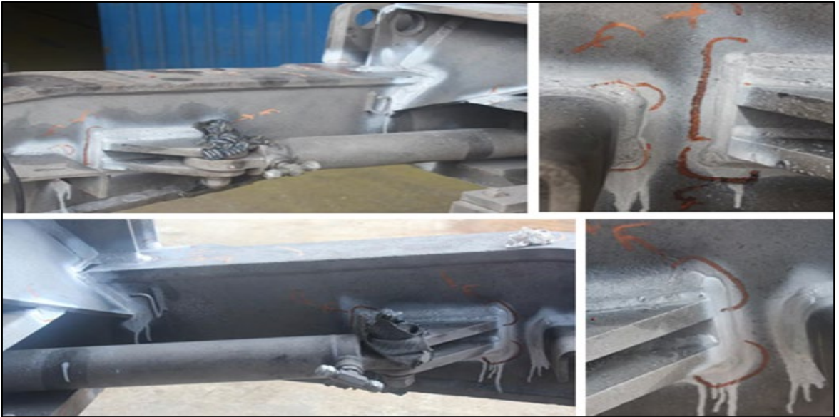
Şekil 81. Alt şasinin arka kısmındaki dönüş silindirlerinin şasiye bağlantı braketlerinin kaynaklı bölgelerindeki hatalar
