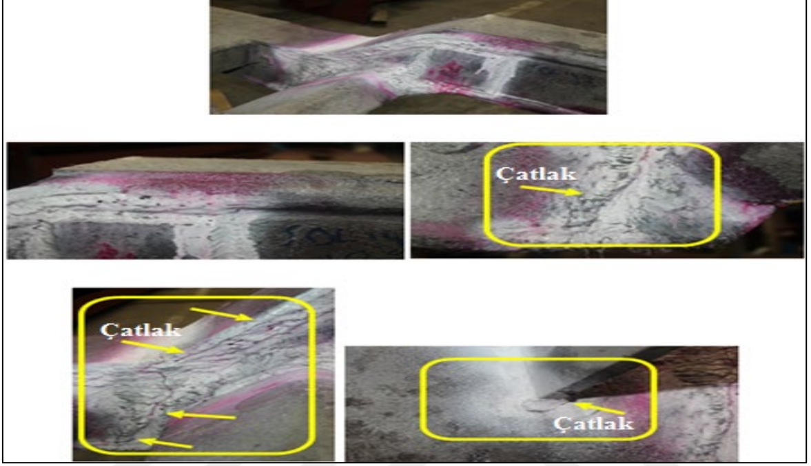
Şekil 44. Üst şaside belirtilen 3 numaralı kısma ait detay görüntüler
