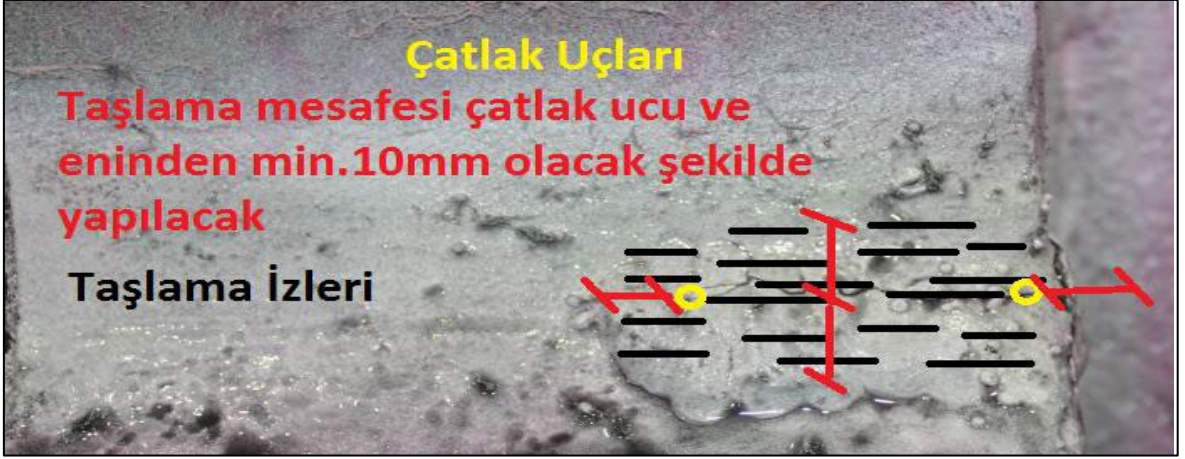
Şekil 56. Aşırı ilerlememiş çatlakların taşlama işlem prosedürü
