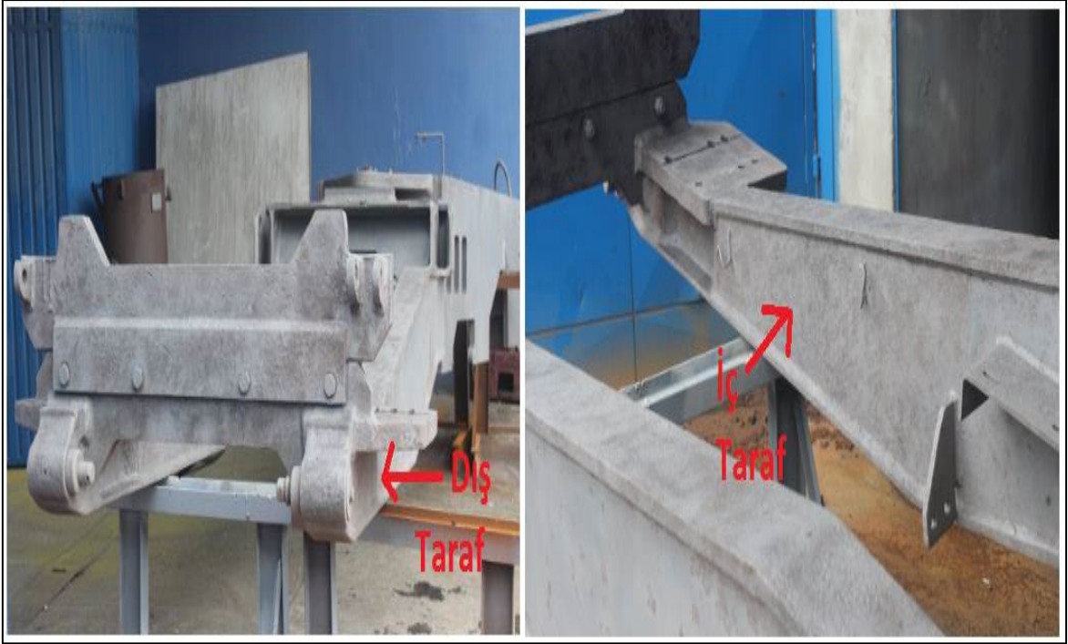
Şekil 67. Alt şaside parça değişimi yapılan kısmın iç ve dış tarafının gösterimi
