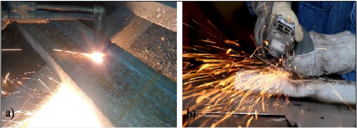
Şekil 58. a) Oksijenle kesme, b) Kesme taşıyla kesme
