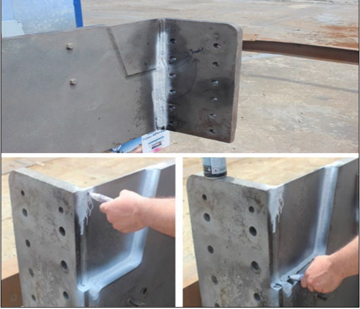
Şekil 79. Alt şasinin ön kısmının baş tarafında görülen hatalar
