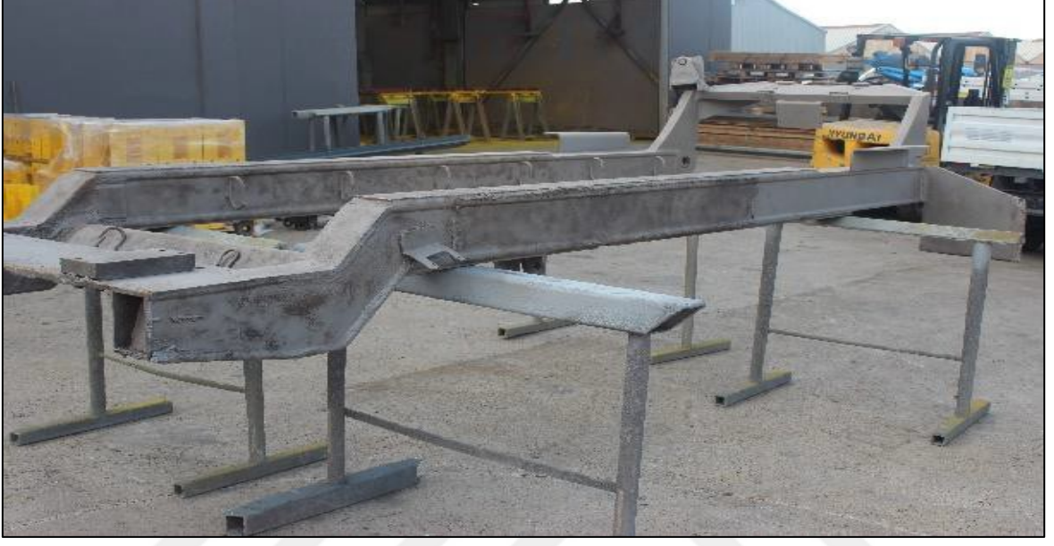
Şekil 39. Kumlama sonrası üst şasinin genel görünümü
