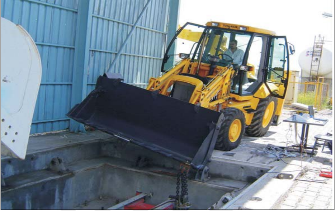
Şekil 13. Test standında hidrolik sistem ile kepçenin uç tırnağından eksantrik kuvvet uygulanması [13].
