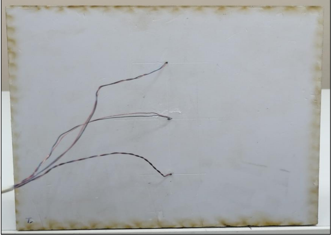
Şekil 24. Deney örneği yüzeyinde termoelemanların bağlantısı
