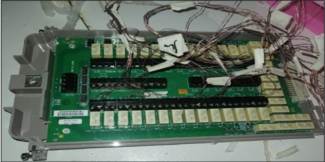
Şekil 25. Termoelemanların okuyucu karta bağlantısı
