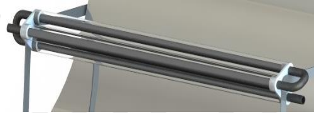
Şekil 2.5. Alıcı boru tasarımı (2.tasarım-3 geçişli)
