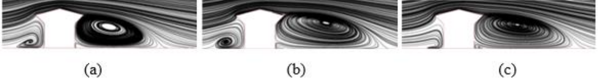
Şekil 4.7. z=50\text{mm} 'de 15^\circ çatı ve 45^\circ saçak eğimine sahip bina modeli etrafındaki hesaplanmış akış alanları (a) Standard k- \epsilon (b) RNG k- \epsilon (c) Realizable k- \epsilon
