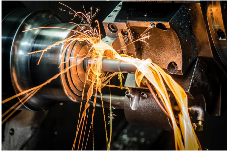
Şekil 1. Isıl işlem görmüş yüksek sertlikte bir parçanın tornalanması
