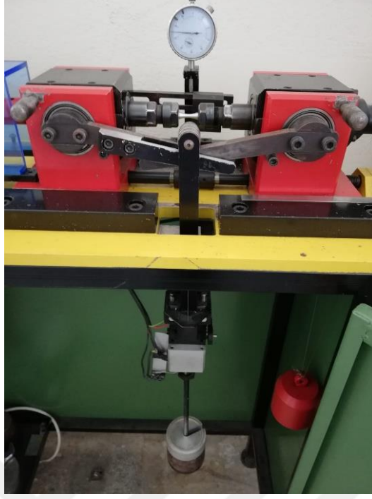
Şekil 6. Yorulma deney makinesine manuel olarak ağırlık asılması
