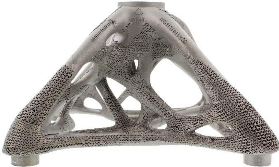
Şekil 1.2. Mimaride kullanılan cam duvar desteğinin topoloji optimizasyonu [5].
