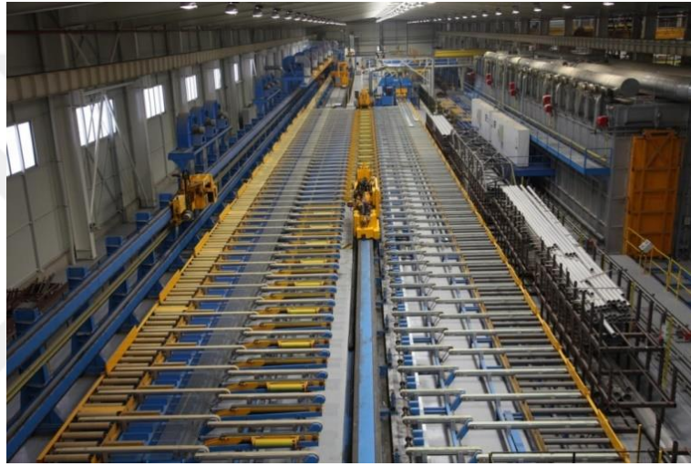
Şekil 17. Modern ekstrüzyon pres hattı germe ve soğutma masası [ASASŞ].
