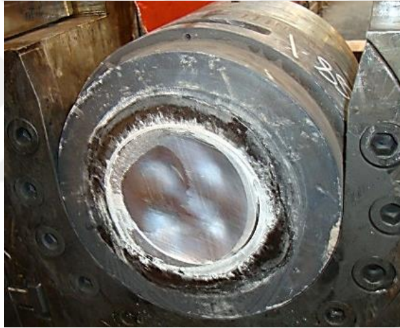
Şekil 47. Kalıp içinde kalan alüminyum ve yeni biyetin kalıba basılma başlangıcı [ASAŞ].
