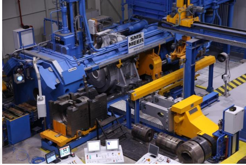
Şekil 15. 55 MN direkt alüminyum ekstrüzyon presi [ASAŞ].
