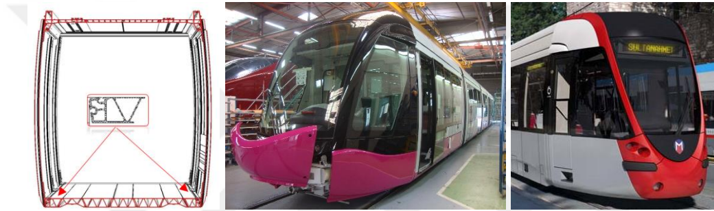
Şekil 58. Karmaşık kesitli alüminyum profillerden oluşan tramvay gövdesi
