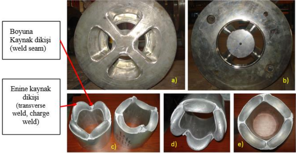
Şekil 40. Yüksek et kalınlığına sahip profilde enine kaynama kusuru ve 4 gözlü profil kalıbı. a)kalıp alüminyum girişi, b) profil çıkış tarafı, c), d), e), enine kaynama noktasından kopan profil numuneleri
