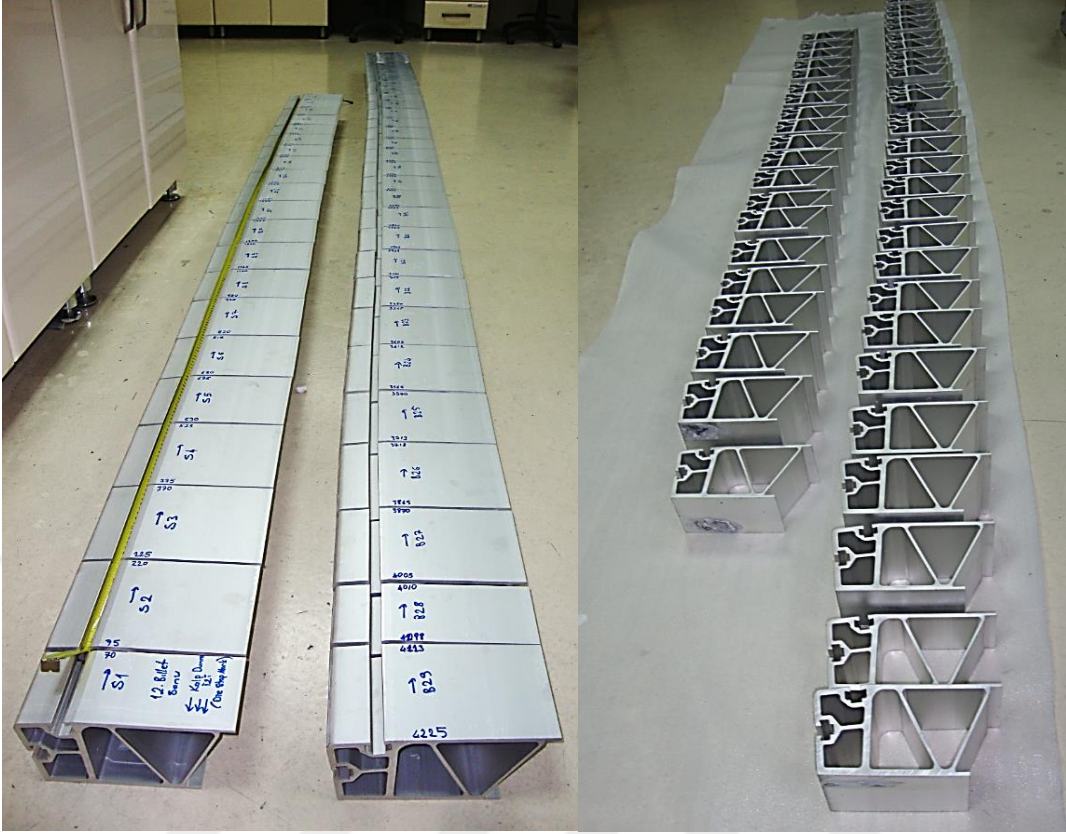
Şekil 94. Biyet başı ve biyet sonundan kesilip numaralandırılan numuneler
