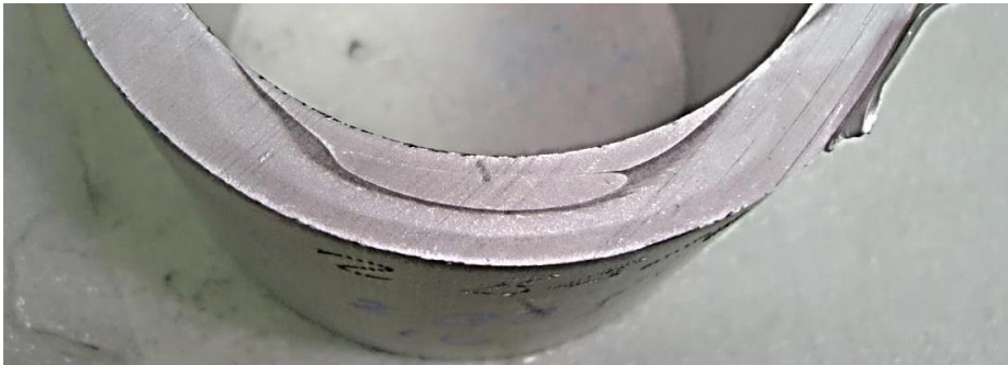
Şekil 43. Boru kesitinde enine kaynamanın başlangıcı ve biyet kabuk kusurunu temizleyerek yerini alması
