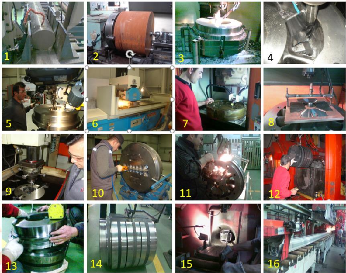
Şekil 21. Alüminyum ekstrüzyon kalıp üretim aşamaları [ASAŞ].
