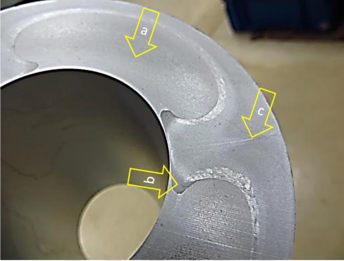
Şekil 28. Boru kesitinde a) biyet biyete alın kaynama (transverse weld), b) biyet kabuğu kusuru (coring, back end defect), c) boyuna kaynama kusuru (seam weld) [24].
