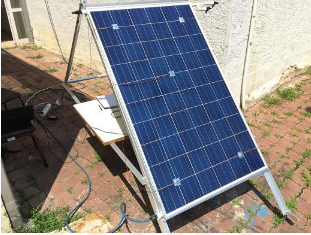
Ek Şekil 1. Yüzey sıcaklık sensörlerinin yerleştirilmesi
