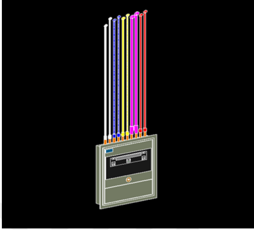
Şekil 63. Medikal gaz tesisatı için vana kutusu ve boru birleşik fabrikasyon modeli
