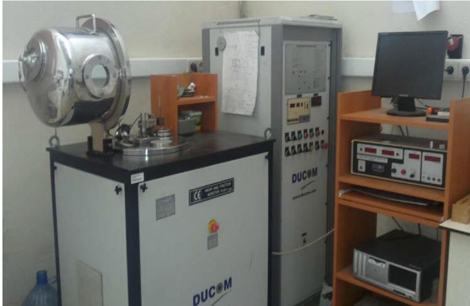
Şekil 23. Ball-on-disk esaslı sürtünme ve aşınma deneyinin düzeneği
