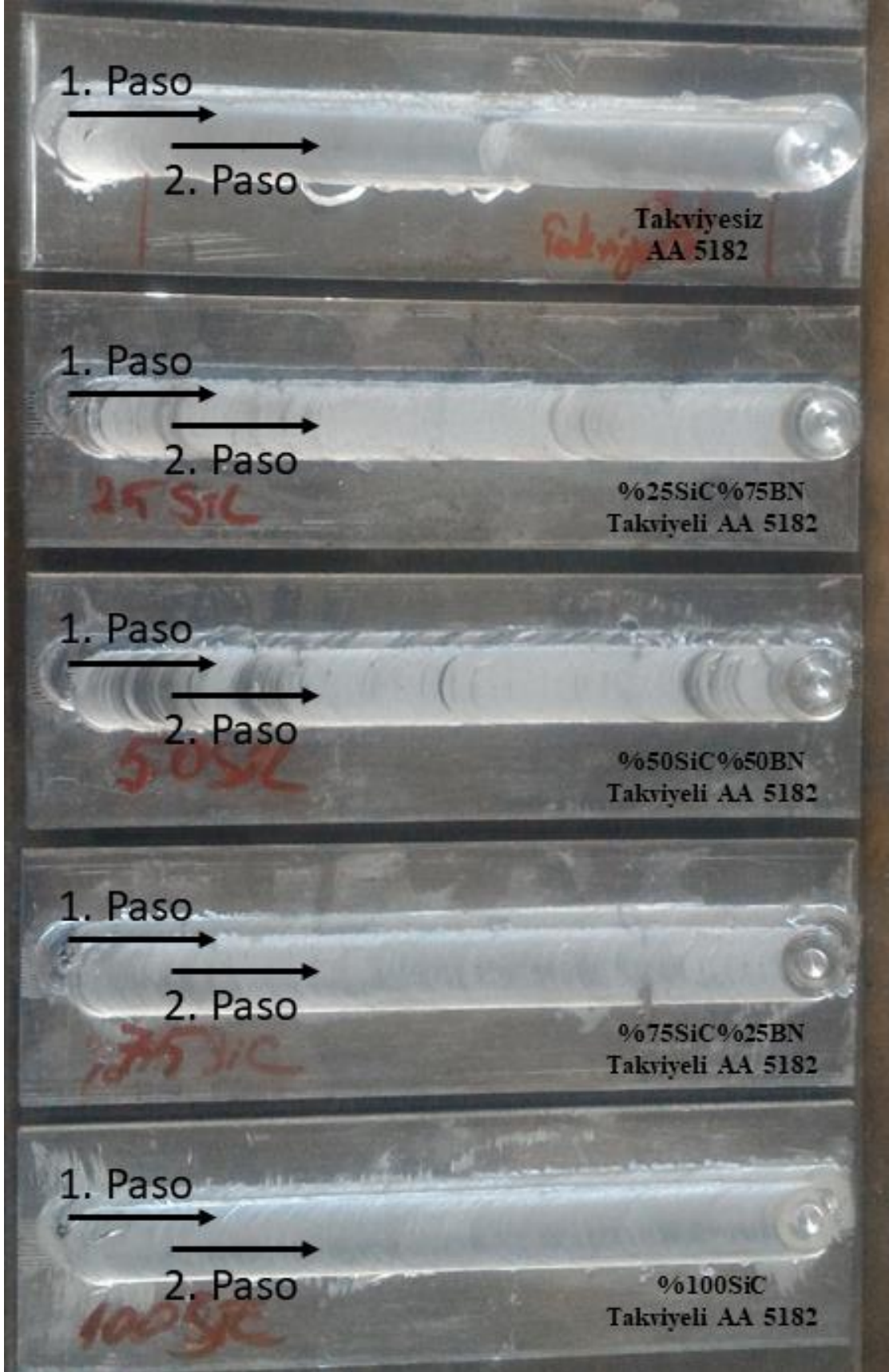
Şekil 30. SKP işlemleri sonrası numunelere ait yüzey görüntüsü.
