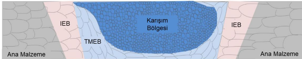
Şekil 4. Sürtünme Karıştırma Prosesi uygulanmış malzemedeki bölgeler.
