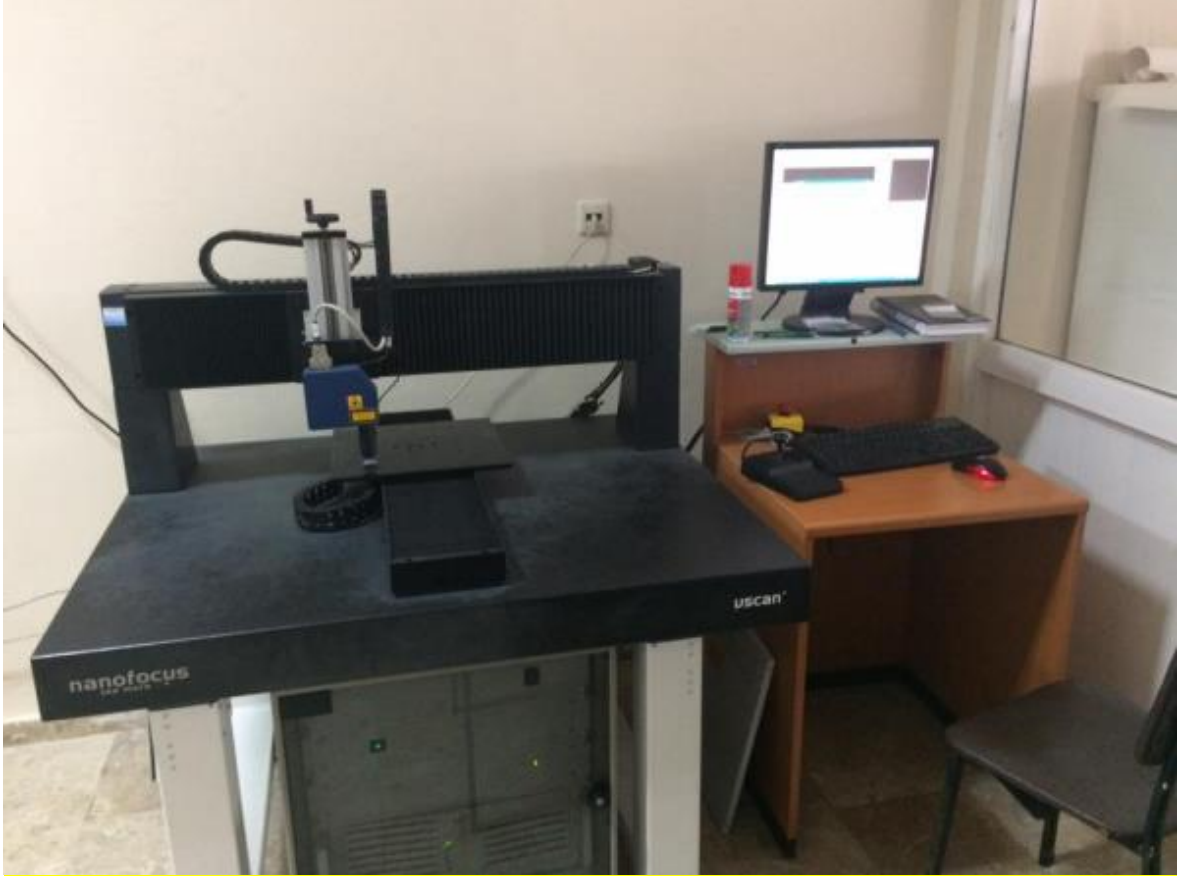
Şekil 2.5. Üç boyutlu yüzey taraması işleminde kullanılan temassız lazer optik profilometre
