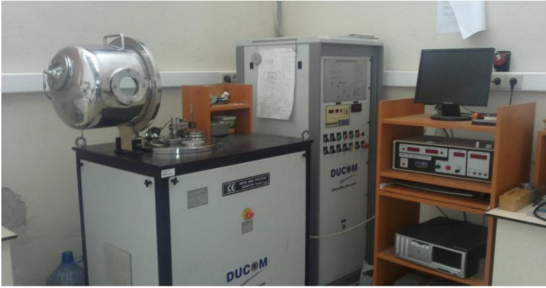
Resim 22. Ball-on-disk tipi sürtünme ve aşınma deney düzeni
