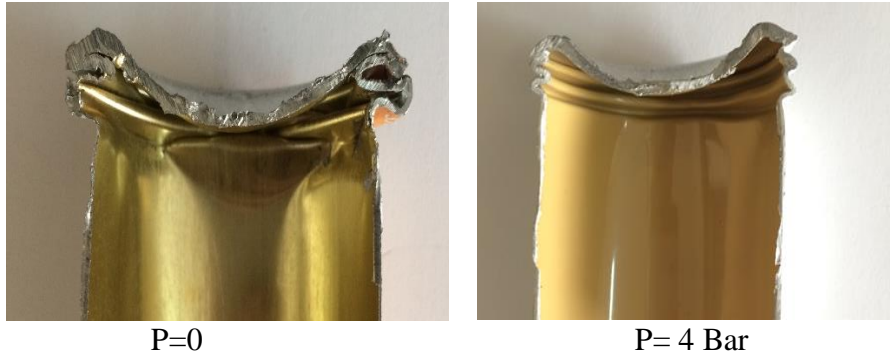
Şekil 3.6. Farklı çarpma hızlarında iç basınçsız ve iç basınçlı tüplerin dinamik deneyler sonrası kesit görüntüleri; a) 15 m/s b) 30 m/s ve c) 40 m/s
