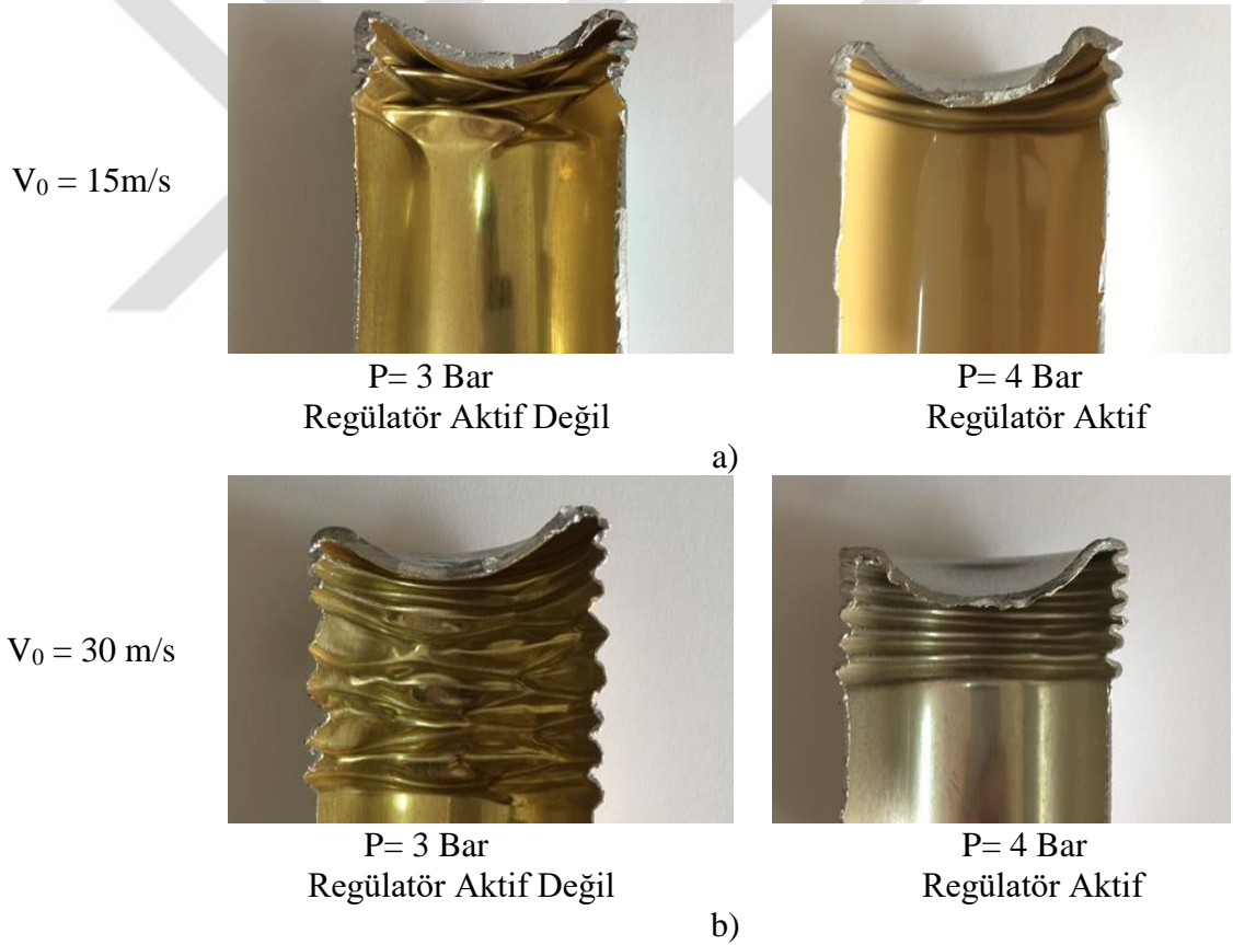
Şekil 3.9. Farklı çarpma hızlarında farklı iç basınçlara sahip tüplerin dinamik deneyler sonrası kesit görüntüleri, a) 15 m/s b) 30 m/s ve c) 40 m/s çarpma hızı için
