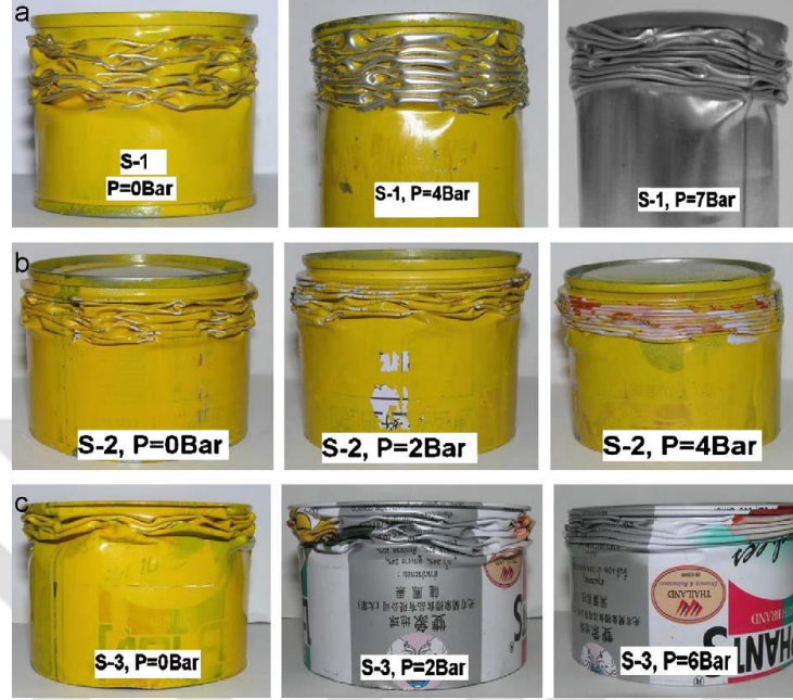
Şekil 1.4. Farklı iç basınçlara sahip ince cidarlı tüplerin statik yükleme sonrası deformasyon görüntüleri a) D/2a = 125 b) D/2a = 150 c) D/2a = 175 [45].
