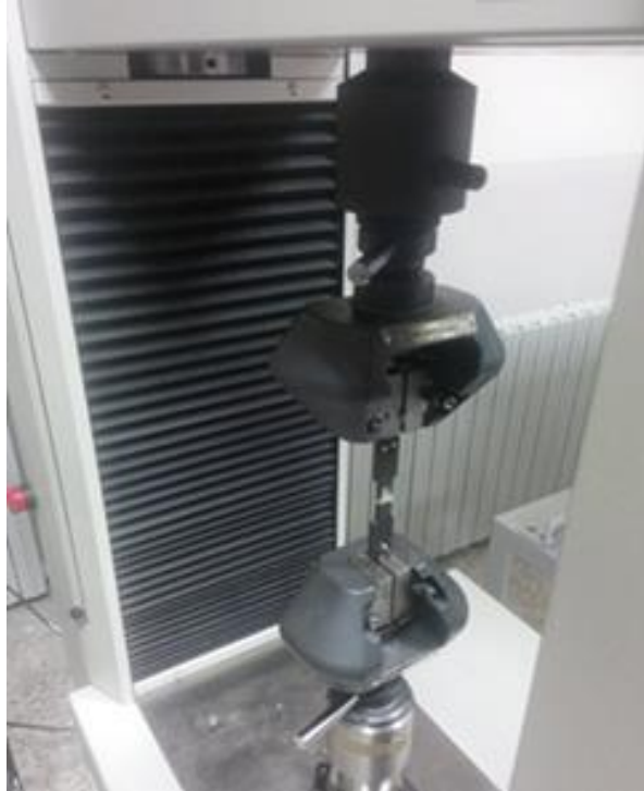
Şekil 2.17. Çekme testlerinin yapıldığı çekme cihazı
