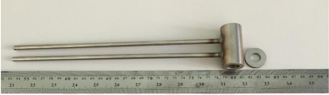
Şekil 2.19. Halka interkonnektör numunesi ve test aparatının kaynak edilmeden önceki görüntüsü
