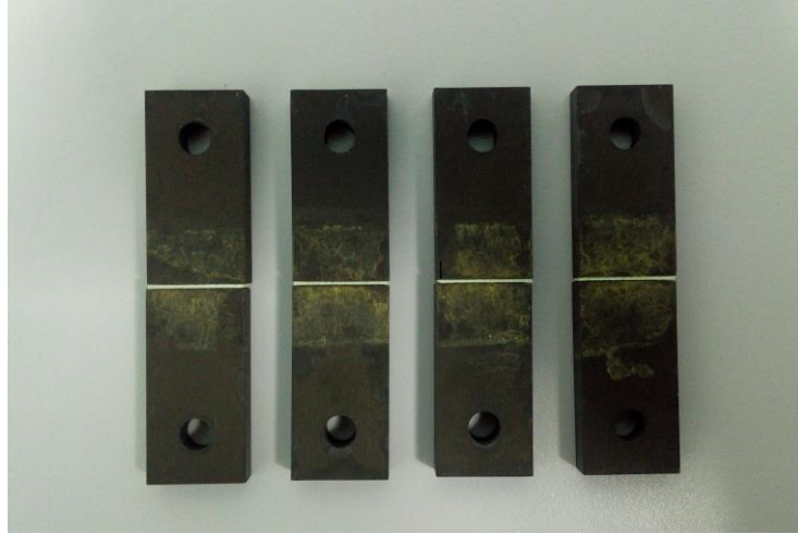
Şekil 2.15. Fırınlamadan sonraki numunelerinin görünümü
