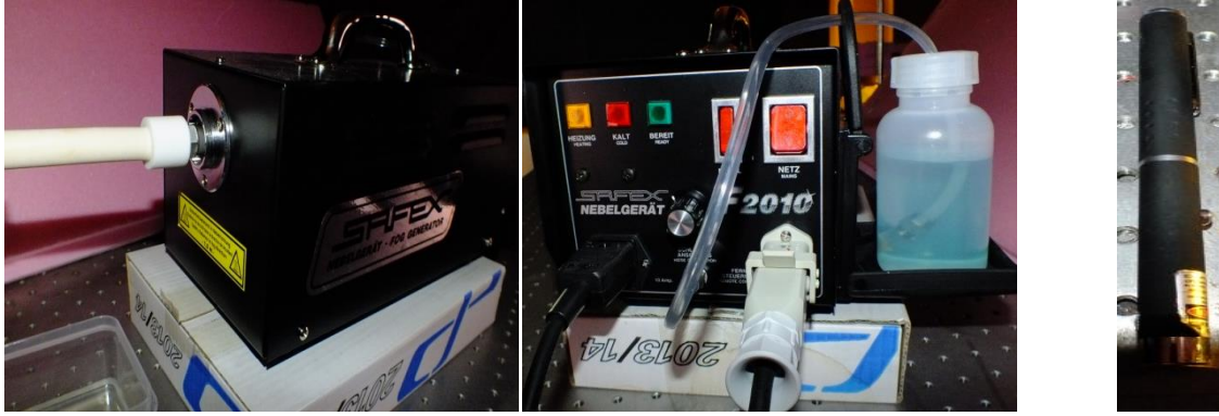
Şekil 18. Sis jeneratörü (a), diyet lazer (b)
