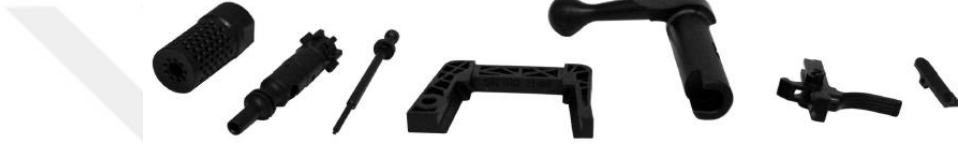
Şekil 13. Nitrüleme işlemi yapılmış piyade tüfeği parçaları [13].
