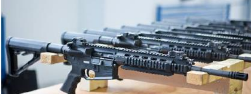
Şekil 12. TM-4 Namlusu, nitrüleme işlemi ile sertleştirilmiş Assault piyade tüfeği, Montenegro [13].
