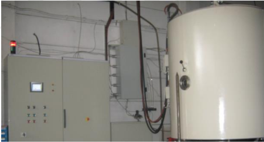
Şekil 15. Plazma (iyon) nitrürleme fırını
