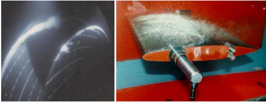
Şekil 26. Bulut kavitasyonu oluşumunun görüntüsü [16].
