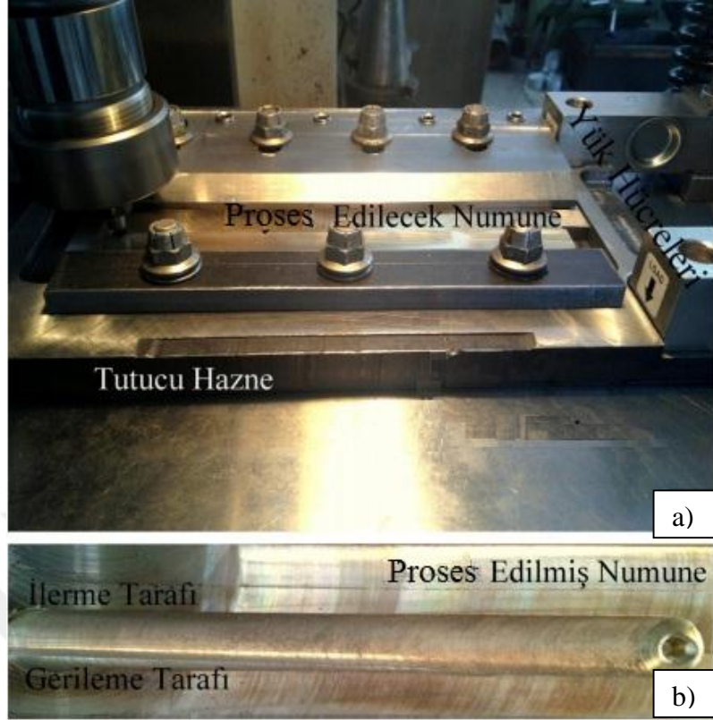
Şekil 41. SKP'nin uygulanış şekli, a) SKP düzeneği ve b) proses edilmiş numune yüzeyi
