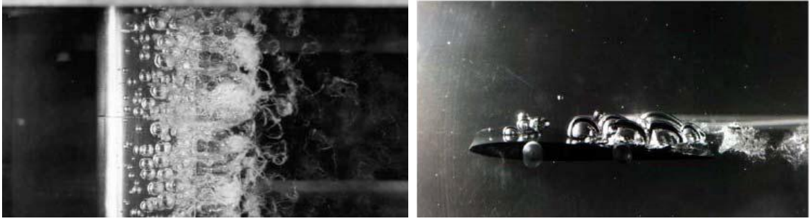
Şekil 23. Kabarcık kavitasyonu oluşumu [16].
