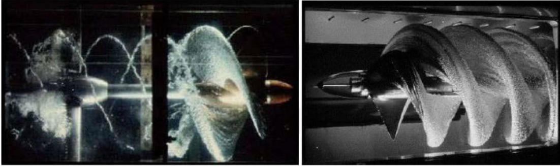
Şekil 25. Tabaka kavitasyonu oluşumu [16].
