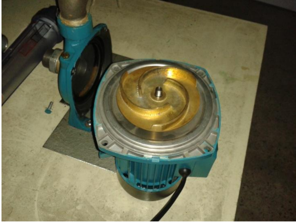
Şekil 49. Orijinal pompa çarkı ve geri eğimli kanatları
