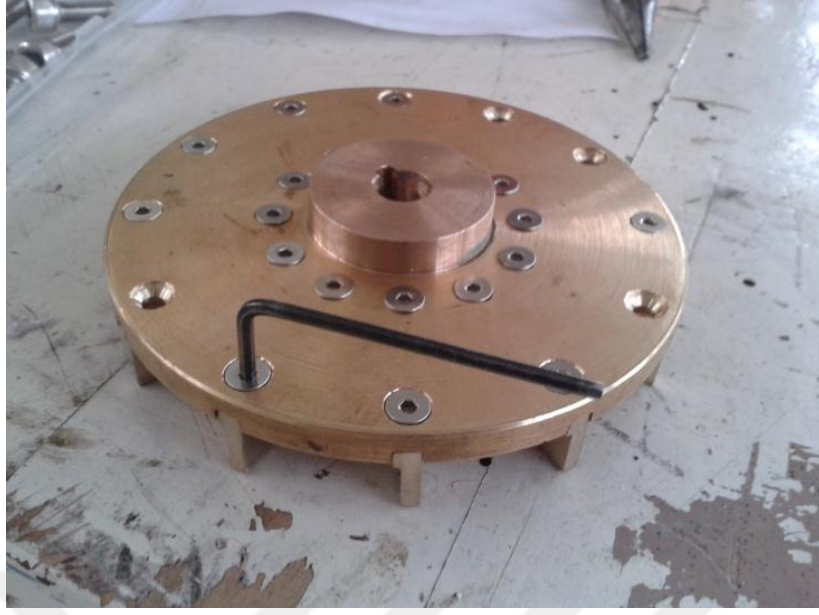
Şekil 51. Alien vidalar ile kanatların çark gövdesine sabitlenmesi
