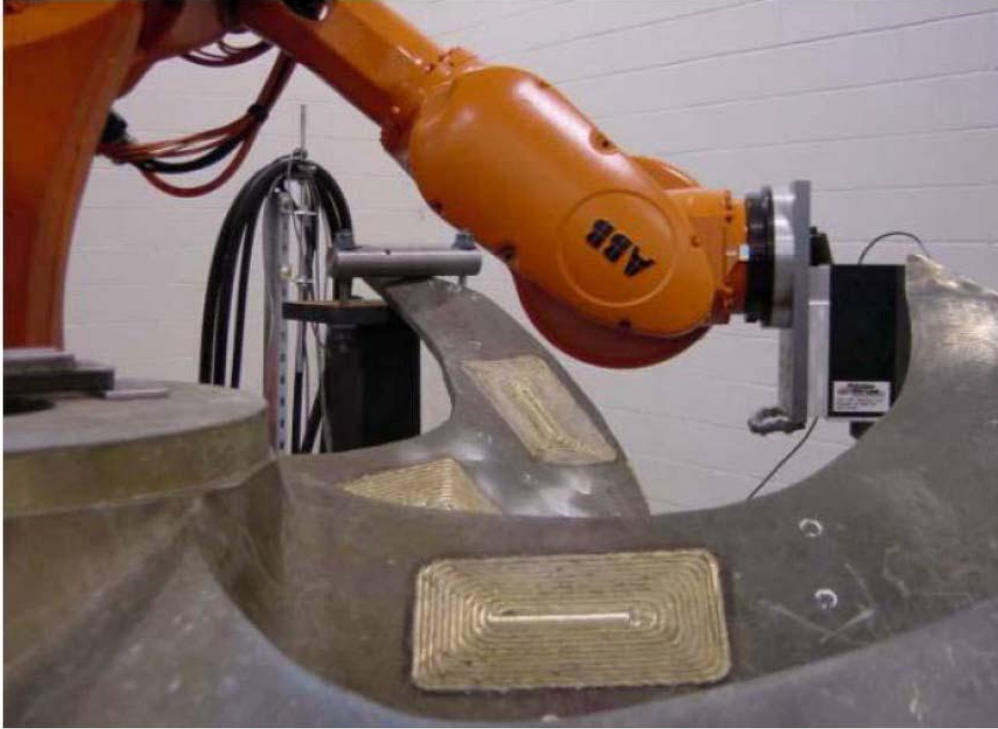
Şekil 7. Bir gemi pervanesi ve SKP yöntemi ile işlenmiş alanlar [13].
