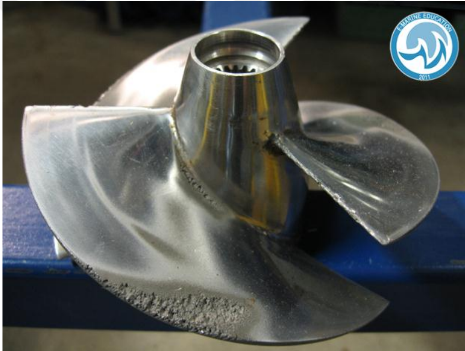
Şekil 30. Bir pervane kanadında kaviteasyon nedeniyle oluşan erozyon [32].
