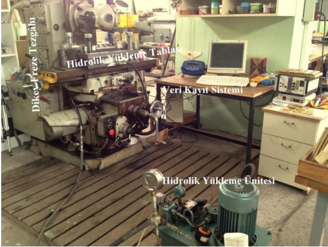
Şekil 35. Sürtünme karıştırma proses donanımının genel görüntüsü
