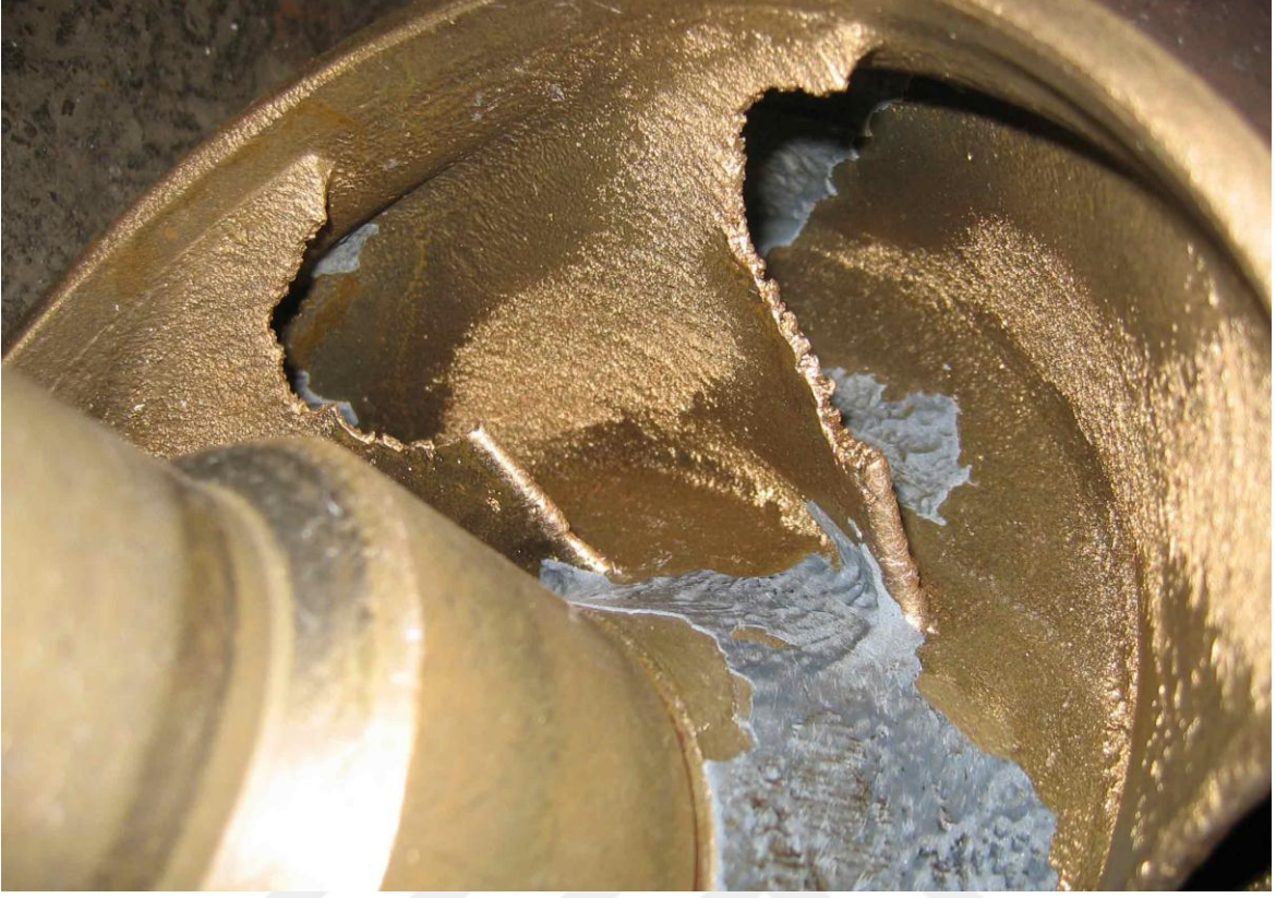
Şekil 14. Bir pompa çarkı üzerinde oluşan kavitasyon hasarı [22].
