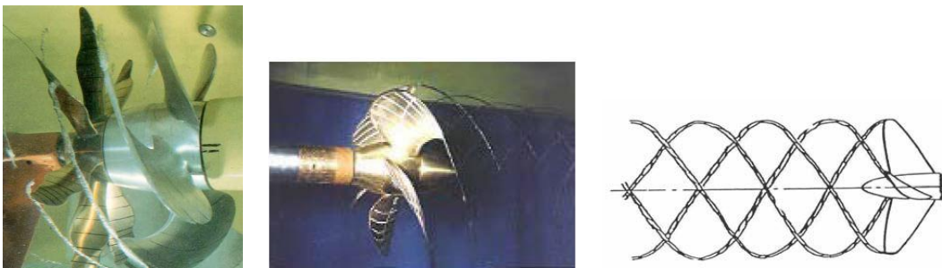
Şekil 21. Uç girdap kaviteasyonu şematik ve gerçek görüntüleri [16].
