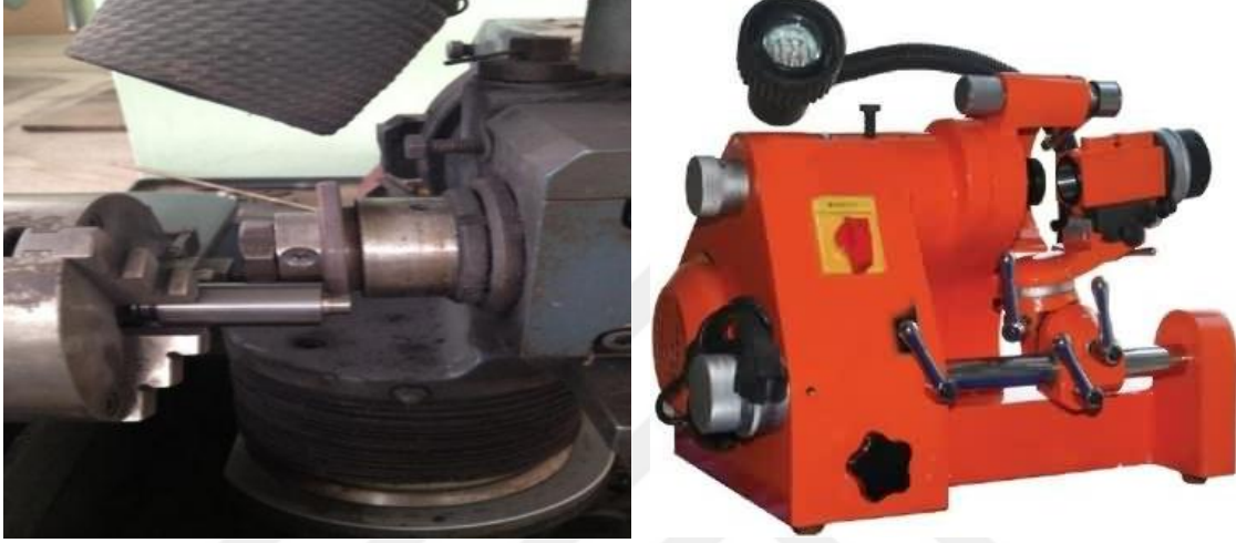
Şekil 37. Proses takımının hazırlanmasında kullanılan taşlama tezgâhları
