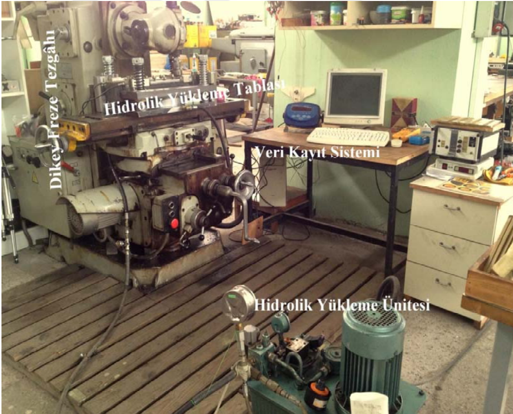
Şekil 30. Sürtünme karıştırma işlemin tezgâh görüntüsü
