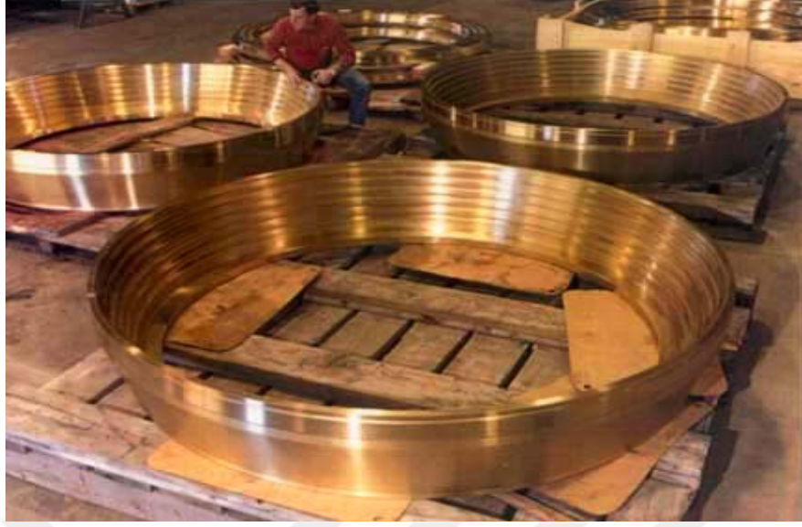
Şekil 4. Savurma döküm ile NAB'dan üretilmiş büyük hidroelektrik türbin aşınma halkaları
