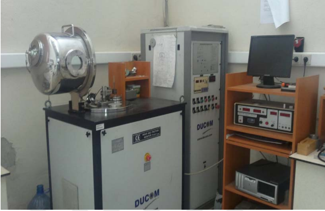
Şekil 36. Ball-on-disk esaslı sürtünme ve aşınma deney düzeneği
