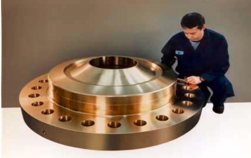
Şekil 1. NAB (C95800)'dan yapılmış yüksek basınçlı santrifüj döküm ile üretilmiş denizaltı fırlatma sisteminde kullanılan flaş
