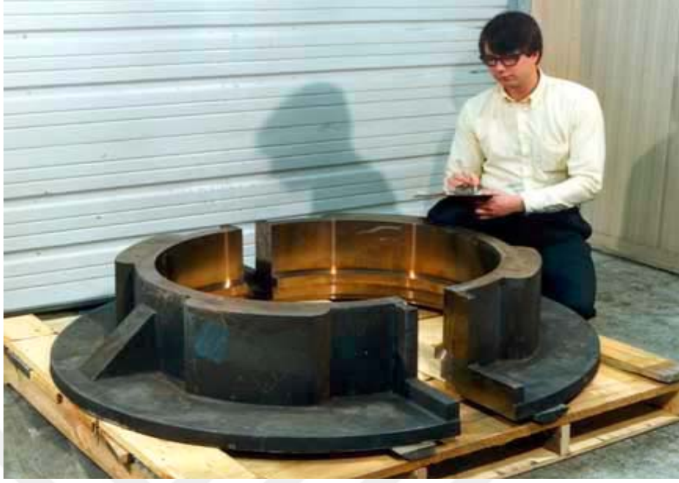
Şekil 2. Savurma döküm ile üretilmiş NAB'dan imal edilmiş pervane mili contası
