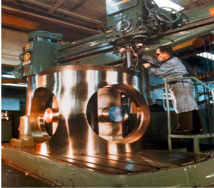
Şekil 3. NAB (C95800) alaşımından üretilen gemi pervane göbeği
