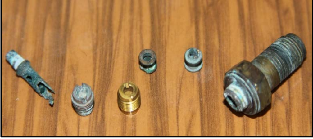
Şekil 14. Karbüratör parçalarında oluşan tahribatlar
