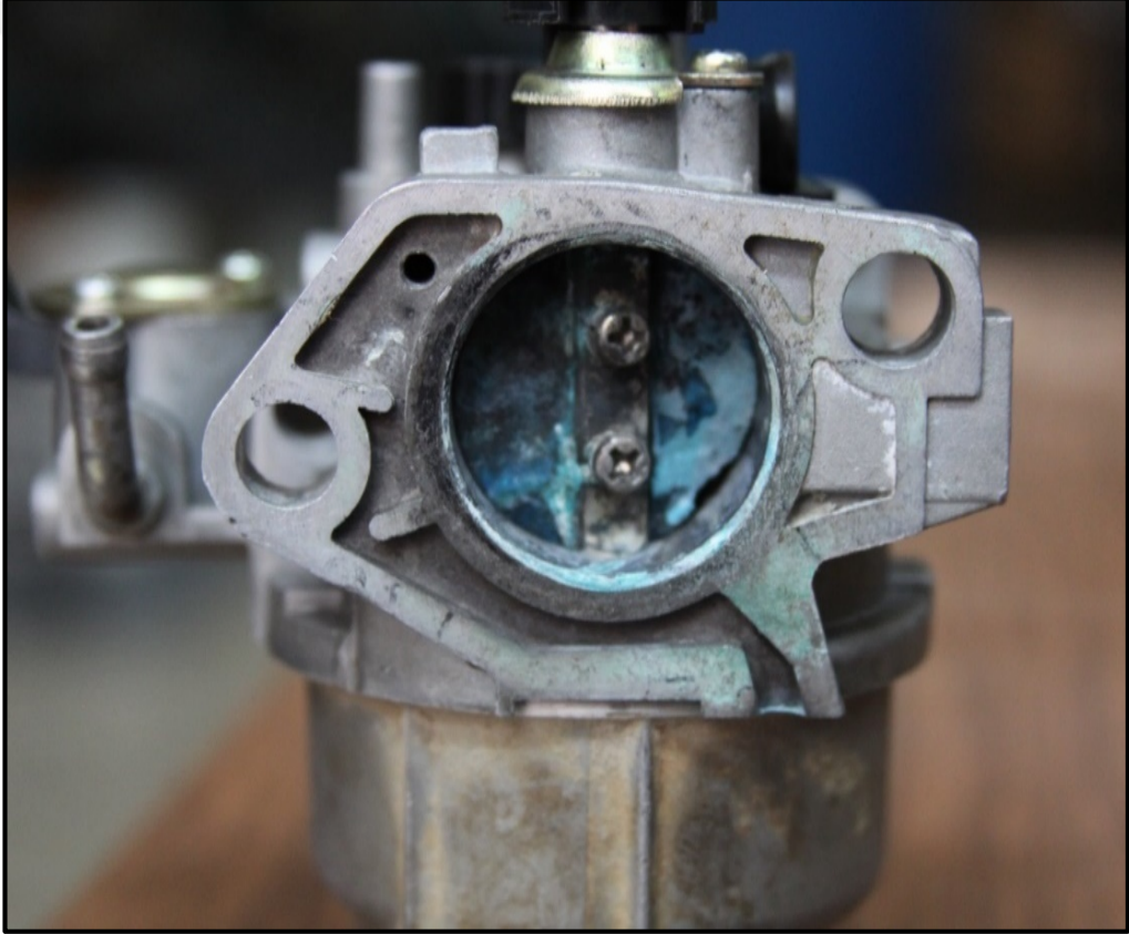
řekil 13. Karbratr i yzeyinde oluřan kalıntı ve tahribat
