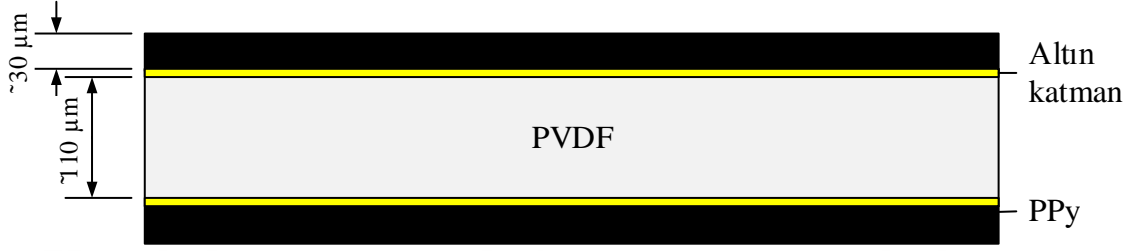
Şekil 1.4. Kullanılan üç katmanlı KEP eyleyici yapısı
