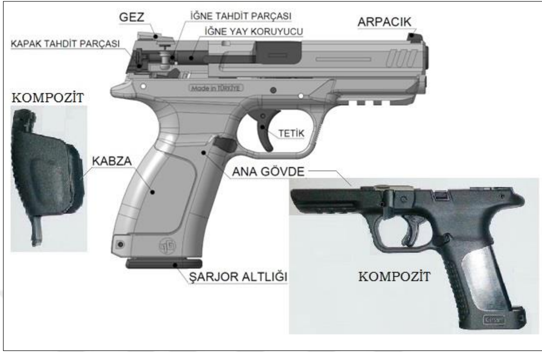
Şekil 3. Polimer kompozit esaslı özgün tabanca şematik resmi [2]
