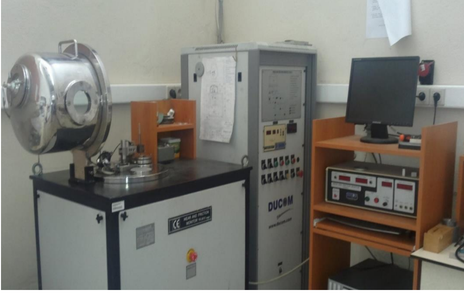
Şekil 14. Ball on disk esaslı sürtünme ve aşınma deney düzeneği
