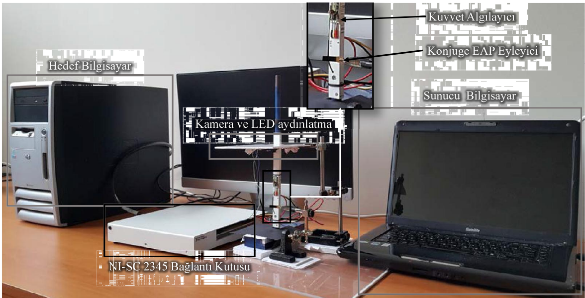
Şekil 3.16. Görüntü tabanlı kontrol ile hibrit kontrol çalışması için kullanılan deney düzenegi
