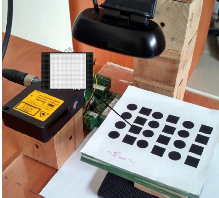
Şekil 2.12. Piksel-milimetre dönüşüm katsayısının belirlenmesi
