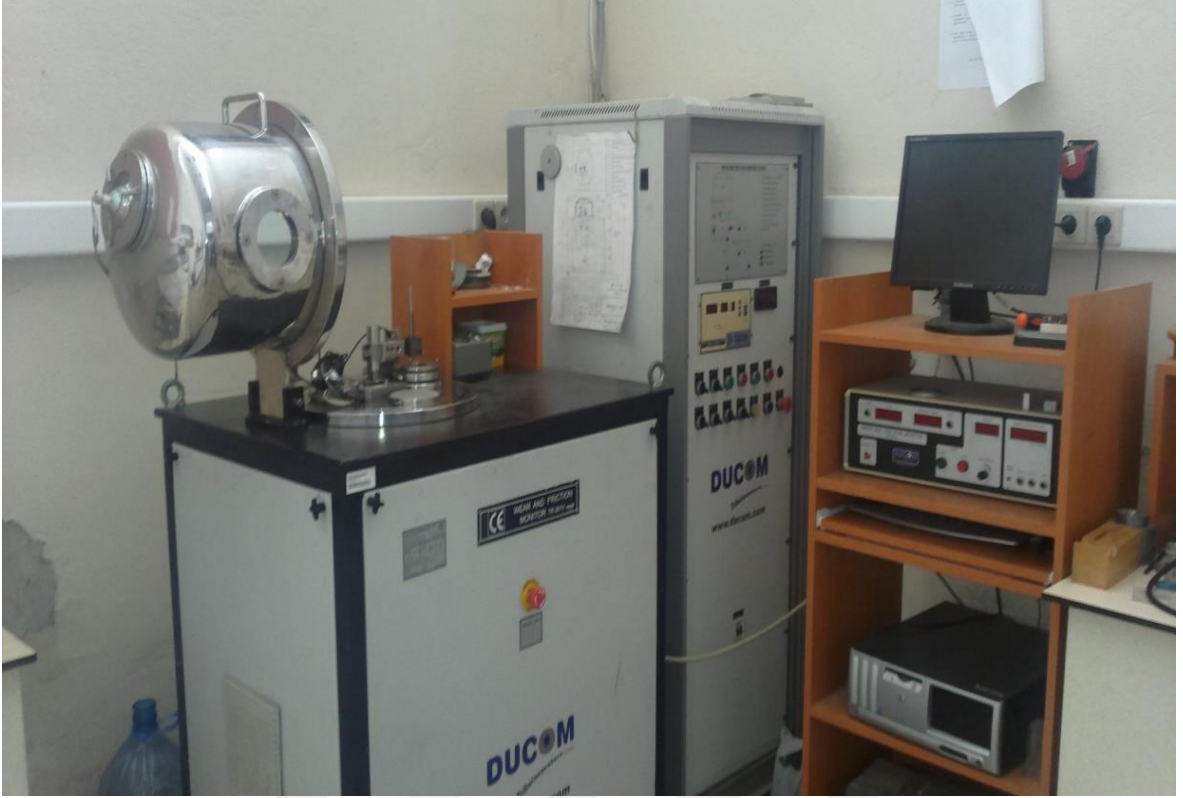
Şekil 36. Ball on disk esaslı sürtünme ve aşınma deney düzeneği
